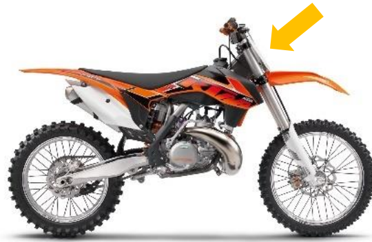
Figura 10: Ubicación frontal de la etiqueta RFID
