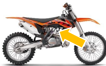
Figura 13: Ubicación de la etiqueta RFID en el centro de la moto
