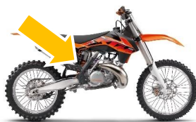
Figura 12: Ubicación central de la etiqueta RFID
