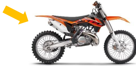
Figura 11: Ubicación posterior de la etiqueta RFID
