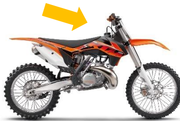
Figura 14: Ubicación superior de la etiqueta RFID
