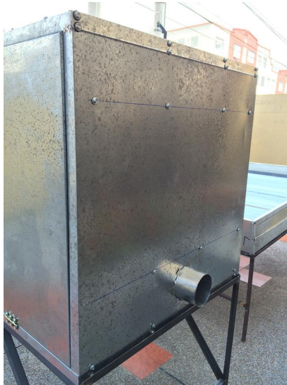
Figura 4.7 Acoples de escape del aire del horno de piezas plásticas. Fuente: Guaña, Altamirano, fotografía tomada agosto del 2015.
