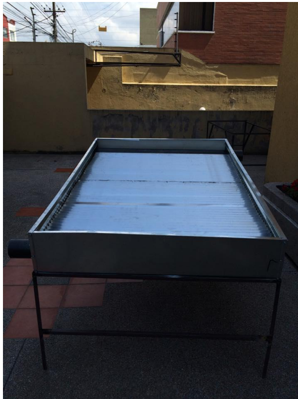
Figura 4.21 Conjunto de placas corrugadas con tubo de entrada y salida de aire montadas sobre todas las bases del colector.
