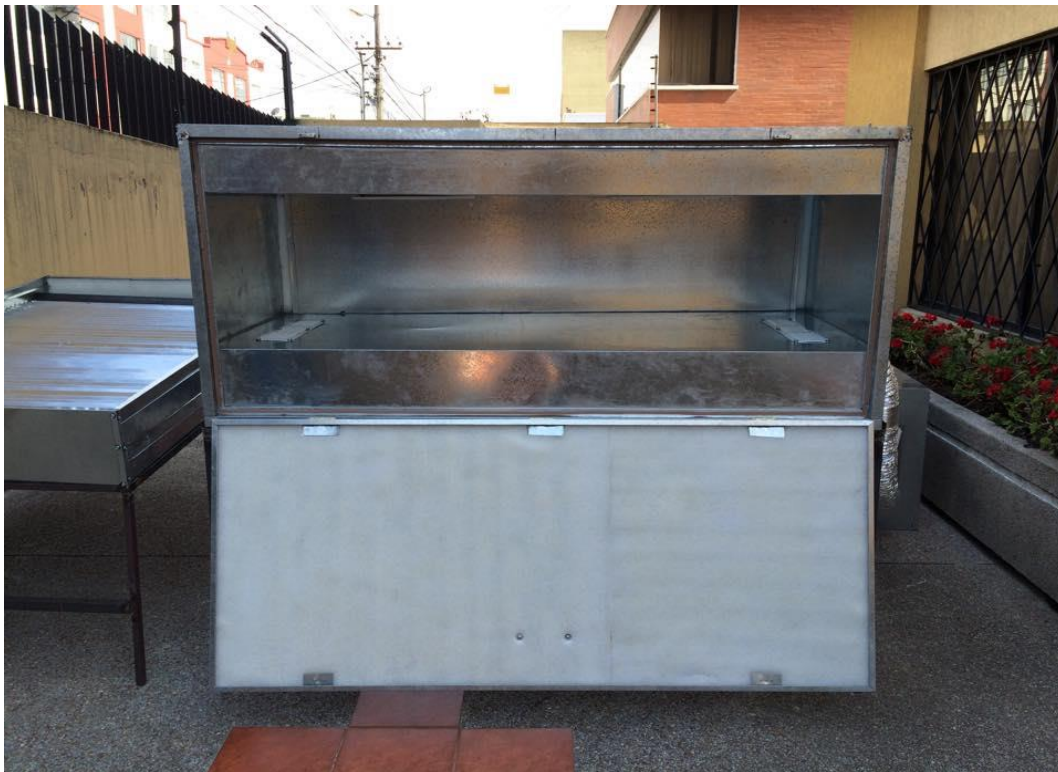
Figura 4.3 Horno de pintura de piezas plásticas Fuente: Guaña, Altamirano, fotografía tomada agosto del 2015.
