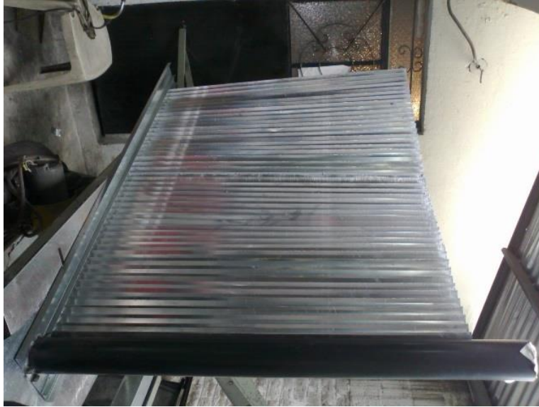
Figura 4.20 Conjunto de placas corrugadas con tubo de entrada y salida de aire montadas sobre base izquierda del colector
