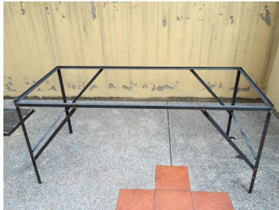
Figura 4.8 Estructura de soporte para el horno de pintura de piezas plásticas. Fuente: Guaña, Altamirano, fotografía tomada agosto del 2015.
