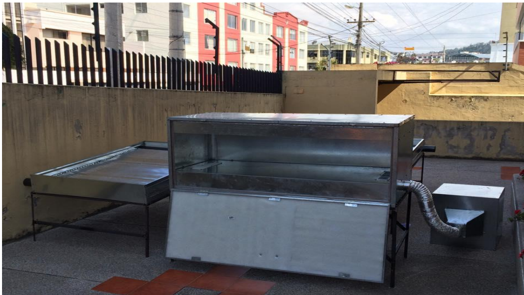
Figura 4.1 Sistema de secado mediante el uso de paneles solares. Fuente: Guaña, Altamirano, fotografía tomada agosto del 2015.
