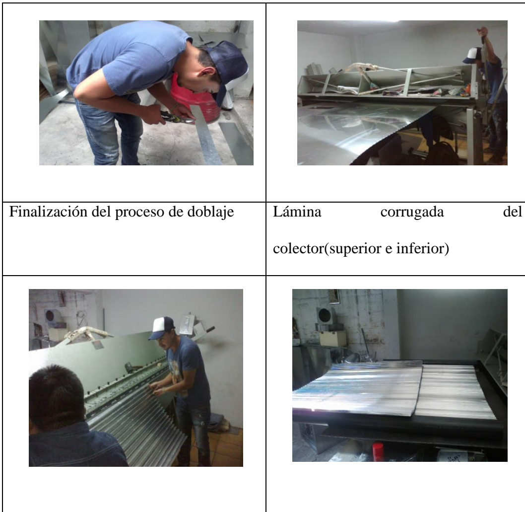
Figura 4.16 Proceso de construcción de lámina corrugada del colector Fuente: Guaña, Altamirano
