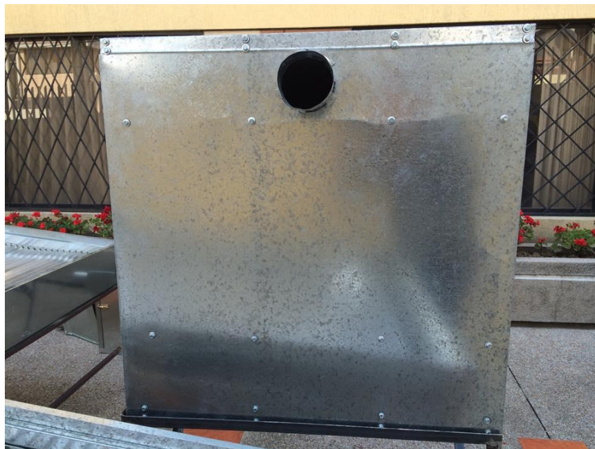
Figura4.6 Acoples de admisión del aire del horno de piezas plásticas. Fuente: Guaña, Altamirano, fotografía tomada agosto del 2015.
