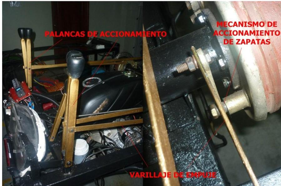
**FIGURA 11: Palancas de accionamiento**
