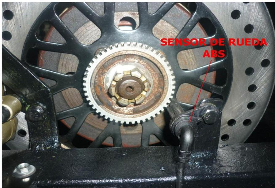
**FIGURA 13: Sensor de velocidad de rueda**
