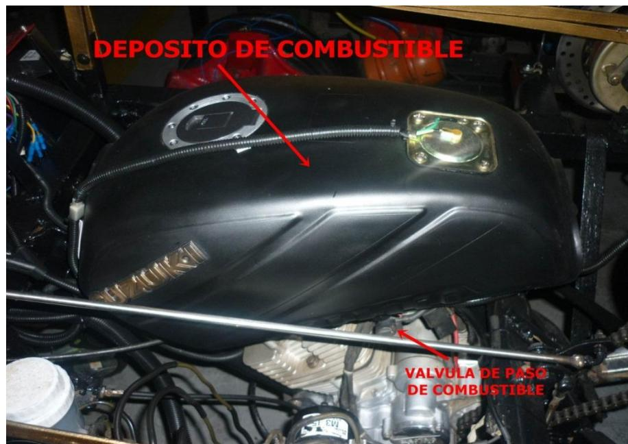
**FIGURA 29: Depósito de combustible**
