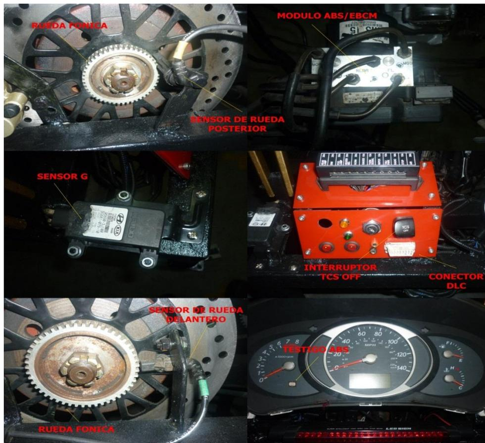
**FIGURA 12: Componentes del sistema de frenos ABS**
