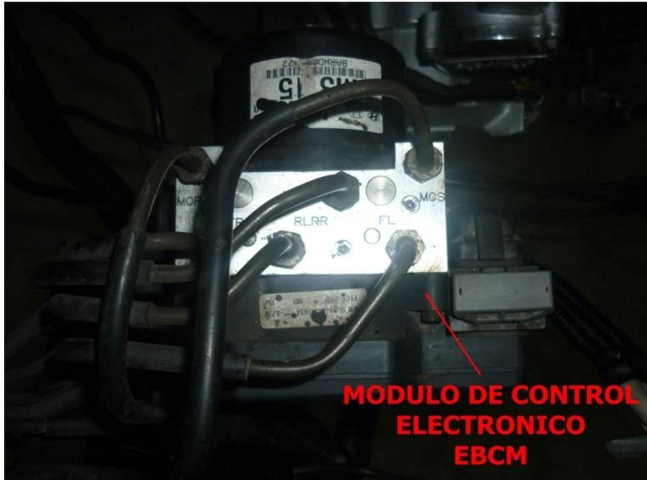
**FIGURA 15: Unidad de control hidráulico EBCM**
