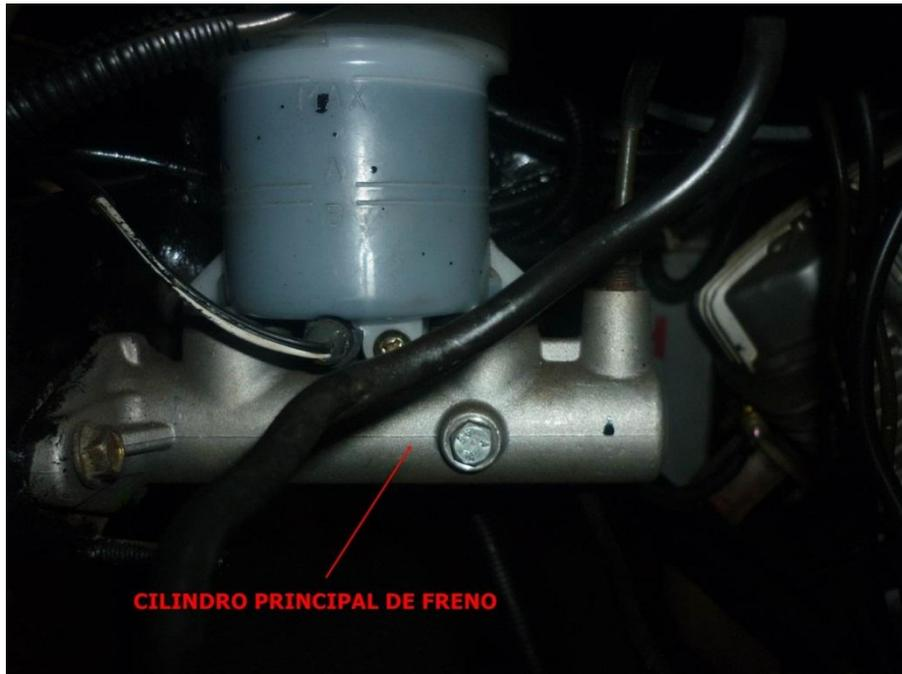
**FIGURA 2: Cilindro principal de freno**
