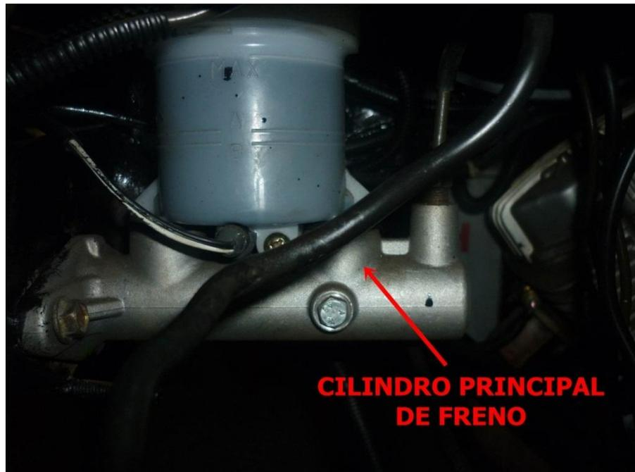
**FIGURA 37: Cilindro principal de freno**
