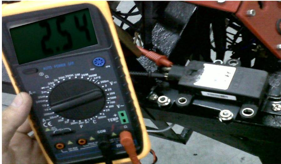
**FIGURA 64: Verificación 1 sensor-G**
