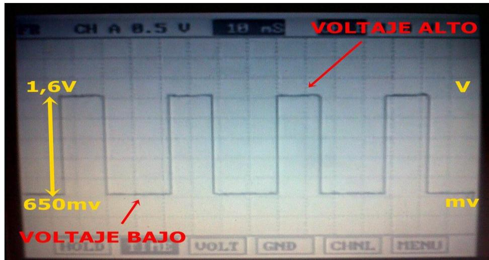
**FIGURA 61: Verificación sensor de rueda**
