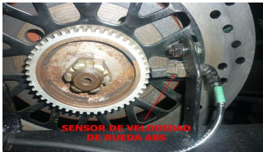
**FIGURA 16: Sensor de velocidad de rueda**
