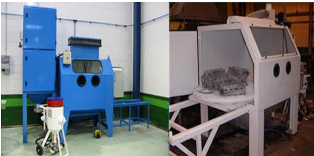
**Figura 3.8:** Sistema de limpieza en cabina.
