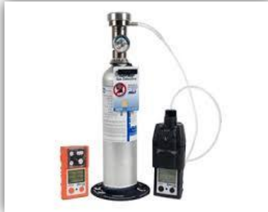
Figura 3.3 Equipo para Monitoreo de Monóxido de Carbono
