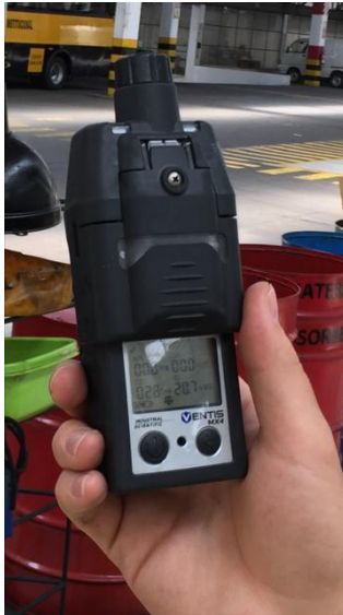
Figura 3.12 Medición de calidad de aire en Hino 500
