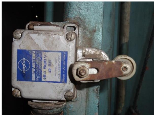
Figura 1.25 Fin de carrera Bernstein Limit Switch 16a 500v NA y NC, del puente de lavado.
