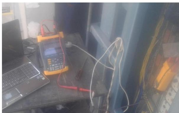
Figura 3.6 Toma de datos de consumo de corriente del motor de rotación del cepillo horizontal
