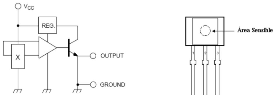
Figura 1.26 Configuración clásica de un sensor de efecto Hall
