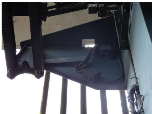
Figura 1.18 Fines de carrera para inclinación de cepillo vertical
