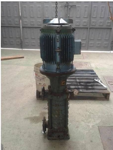
Figura 3.4 Bomba de presión, para lavado de llantas y chasis
