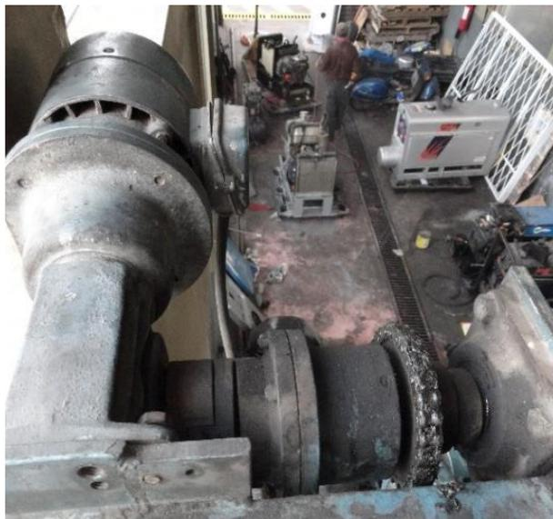
Figura 1.8 inicial Sistema piñón cadena para el movimiento traslacional del cepillo horizontal
