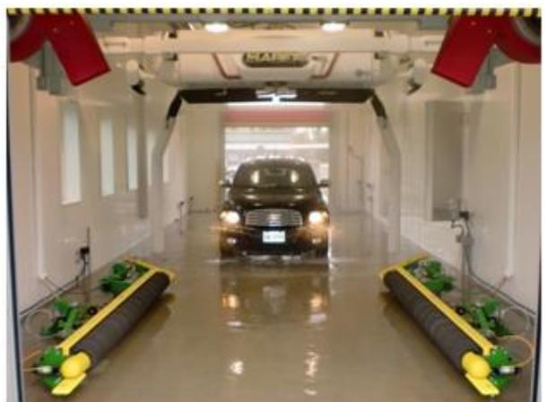
Figura 1.2 a) Lavado sin contacto, vehículo estático, b) Lavado sin contacto, maquina estática, ambos marca EYNA
