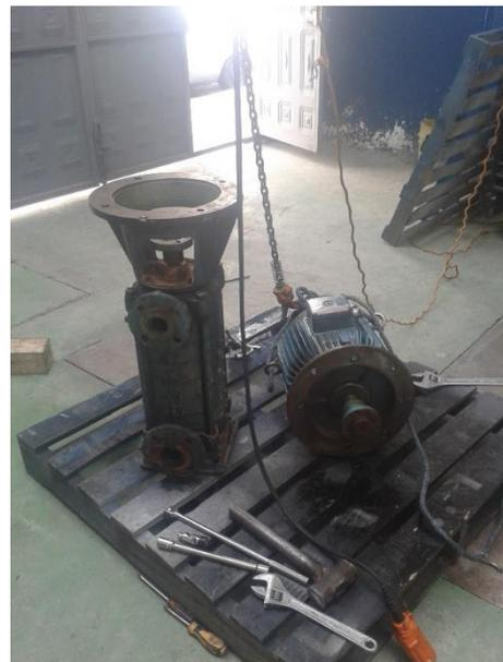
Figura 3.5 Bomba de presión desarmada
