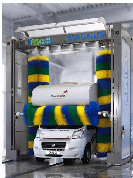
Figura 3.10 Caso en el que el cepillo horizontal tiene que superar un perfil poco usual de un vehículo
