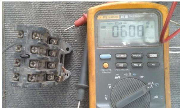
Figura 3.11 Consumo de corriente de contactores de control.
