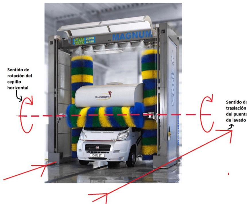
Figura 2.5 Sentido de rotación del cepillo horizontal a favor del movimiento del puente de lavado, adaptada de [26]
