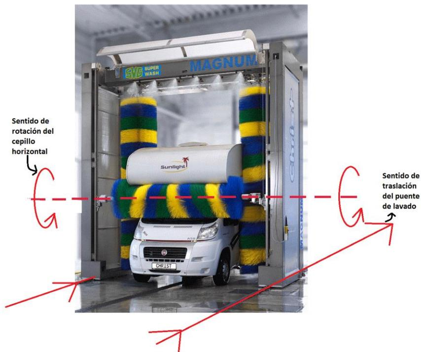
Figura 2.6 Sentido de rotación del cepillo horizontal en contra del movimiento del puente de lavado, adaptada de [26]
