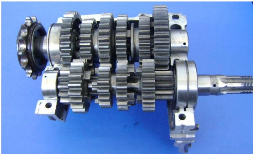
Fig.4.1: Caja de cambios en corte
