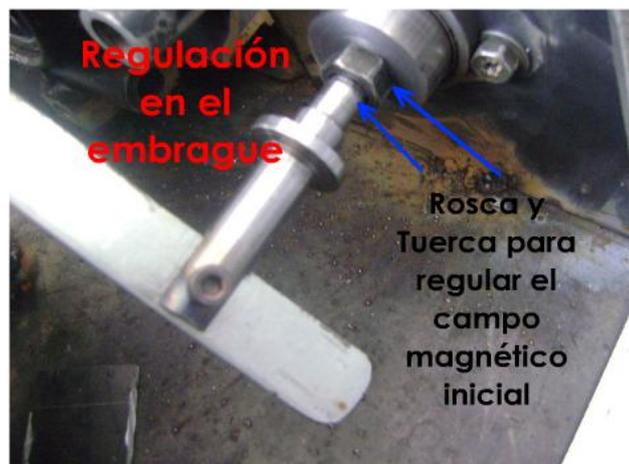
Fig. 4.9: Regulación del embrague
