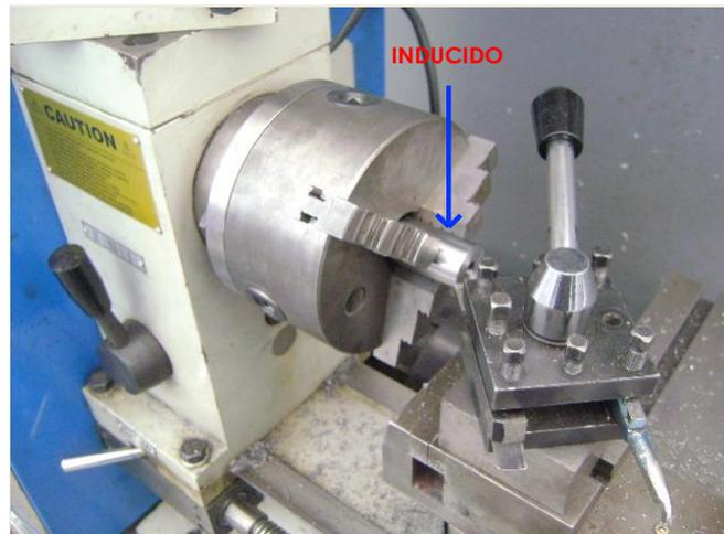
Fig. 4.3: Construcción de los inducido
