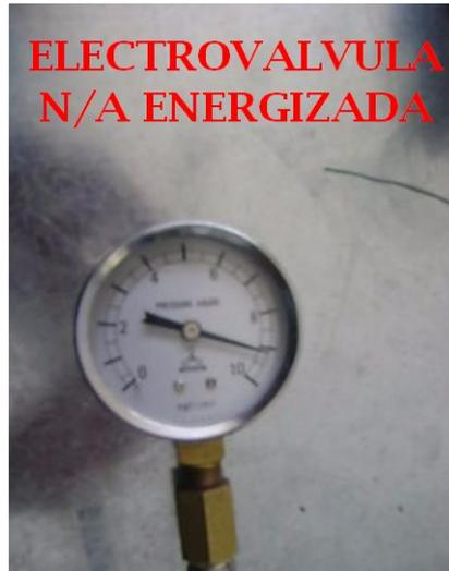
Fig.2.21: Mantenimiento de la presión
