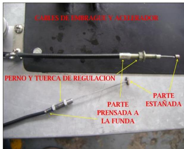
Fig. 4.21: Cable de acelerador y embrague
