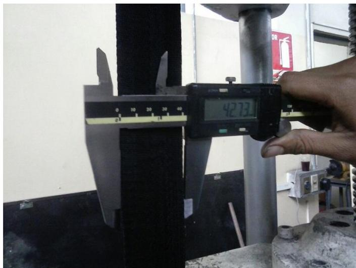
**Figura 4.5** Muestra de cinturón de seguridad Nacional sin deformación
