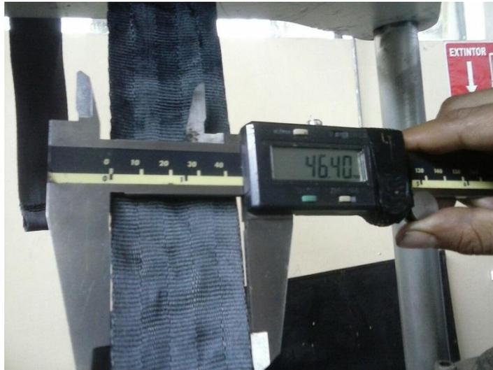
**Figura 4.3** Medida de cinturón de seguridad original deformado
