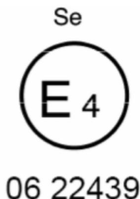
El cinturón que lleve la marca de homologación que figura arriba es un cinturón de tipo especial («S»), equipado con un absorbedor de energía («e») y fue homologado en los Países Bajos (E4) con el número 0622439; el Reglamento ya incorporaba la serie 06 de enmiendas cuando se expidió la homologación.
