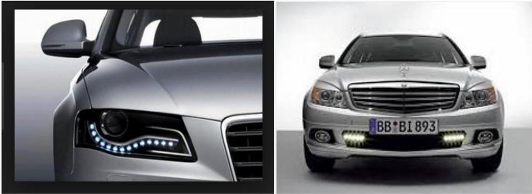
**Figura 1.4** Luz diurna instalada directamente en el faro central y luces diurnas instaladas en la parte inferior del guardachoque delantero.
