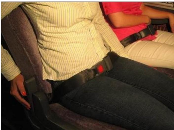
**Figura 1.10** Cinturones de seguridad de dos puntos.
