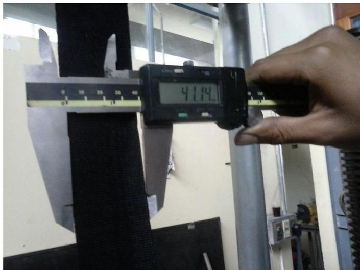
**Figura 4.4** Medida de cinturón de seguridad Nacional deformado
