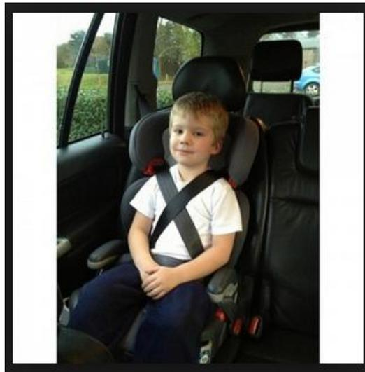
**Figura 1.14** Cinturón de seguridad en forma de “X”.
