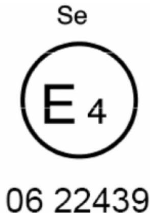
**Figura 2.3** Ejemplo de una homologación de la UNCE tipo Se con su respectivo apéndice.
