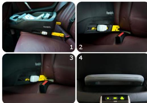
**Figura 2.4** Ejemplo de instalación de un sistema ISOFIX.
