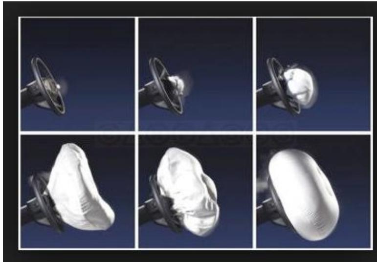
**Figura 1.6** Secuencia al momento de inflarse el airbag del conductor.
