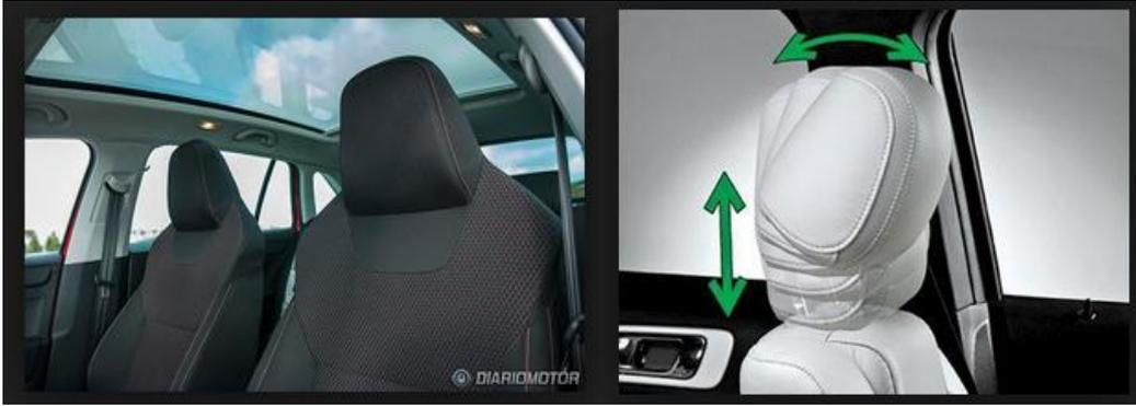
**Figura 1.7** Reposacabezas fijo o anclado al asiento y Reposacabezas ajustable
