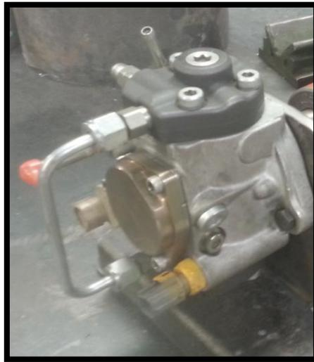
**Figura 2.8** Bomba alta presión HP3.
