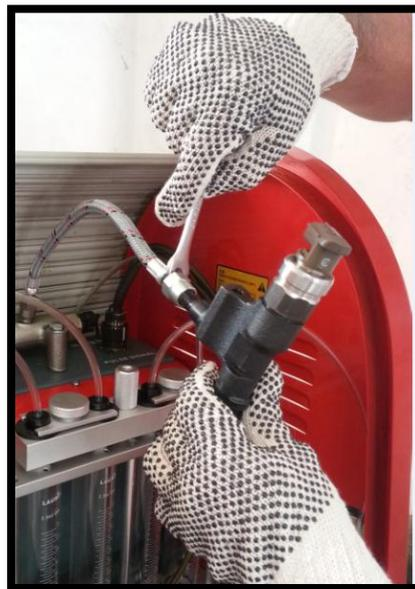
Figura 4.13 Ajuste cañería con inyector 2.
