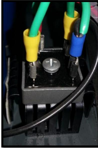
**Figura 2.18** Puente rectificador.
