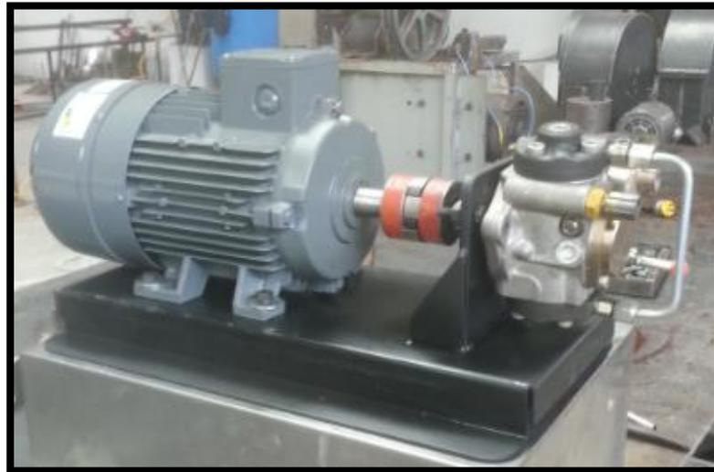
**Figura 2.11** Funcionamiento de base del motor y bomba.
