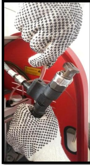
**Figura 4.26** Conexión de la cañería de retorno 3.
