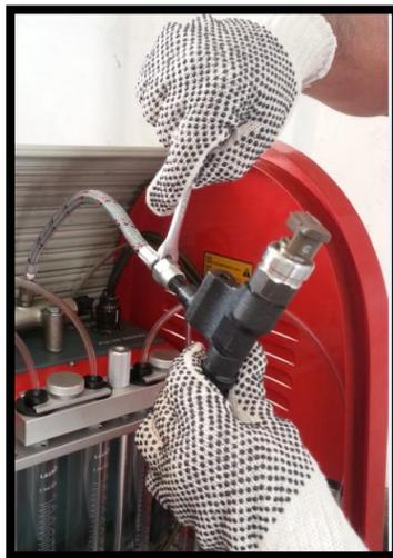
Figura 4.25 Ajuste cañería con inyector 3.
