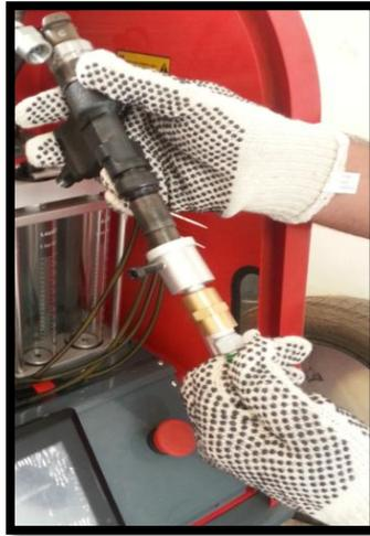
**Figura 4.14** Inserción del acople rápido de bajas 2.
