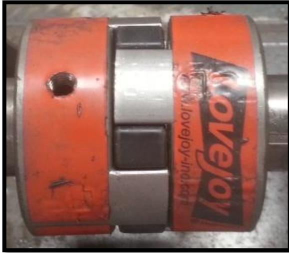
**Figura 2.7** Acoplamiento semiflexible
