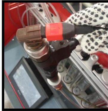
**Figura 4.4** Conector de señal.
