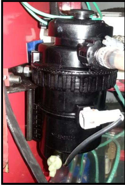
**Figura 2.15** Filtro de combustible diesel.
