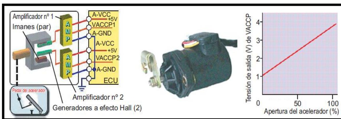
**Figura 1.14** Sensor de generador a efecto hall.
