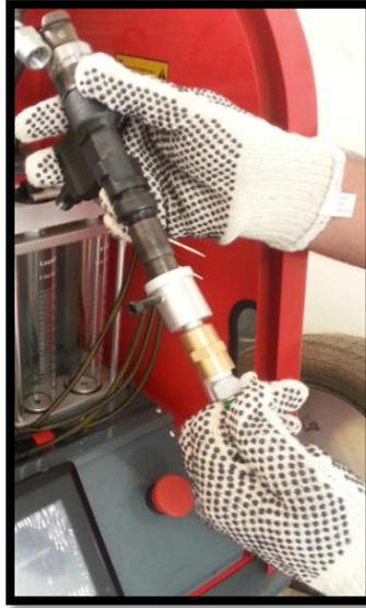
**Figura 4.2** Inserción del acople rápido de bajas.
