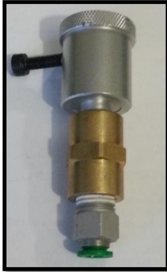
**Figura 2.16** Acople rápido baja presión.
