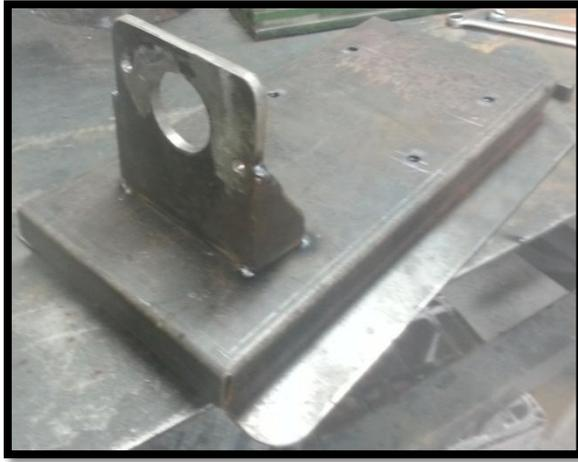
**Figura 2.10.** Base del motor y bomba.
