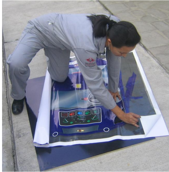
Figura 6. 6: Colocación del Vinil Adhesivo con Diseño en Madera
