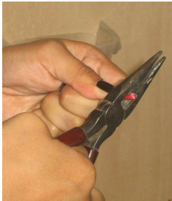
Figura 6. 26: Fabricación de Cables para Conexiones
