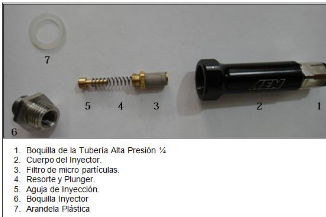
Figura. 19 Inyector en despiece del Sistema de Inyección Agua/Metanol.
