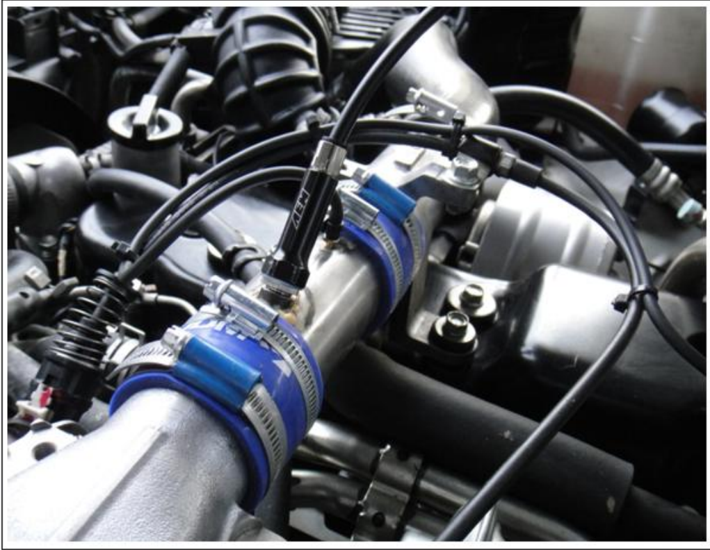
Figura. 35 Instalación final del inyector, cañería y tuberías.
