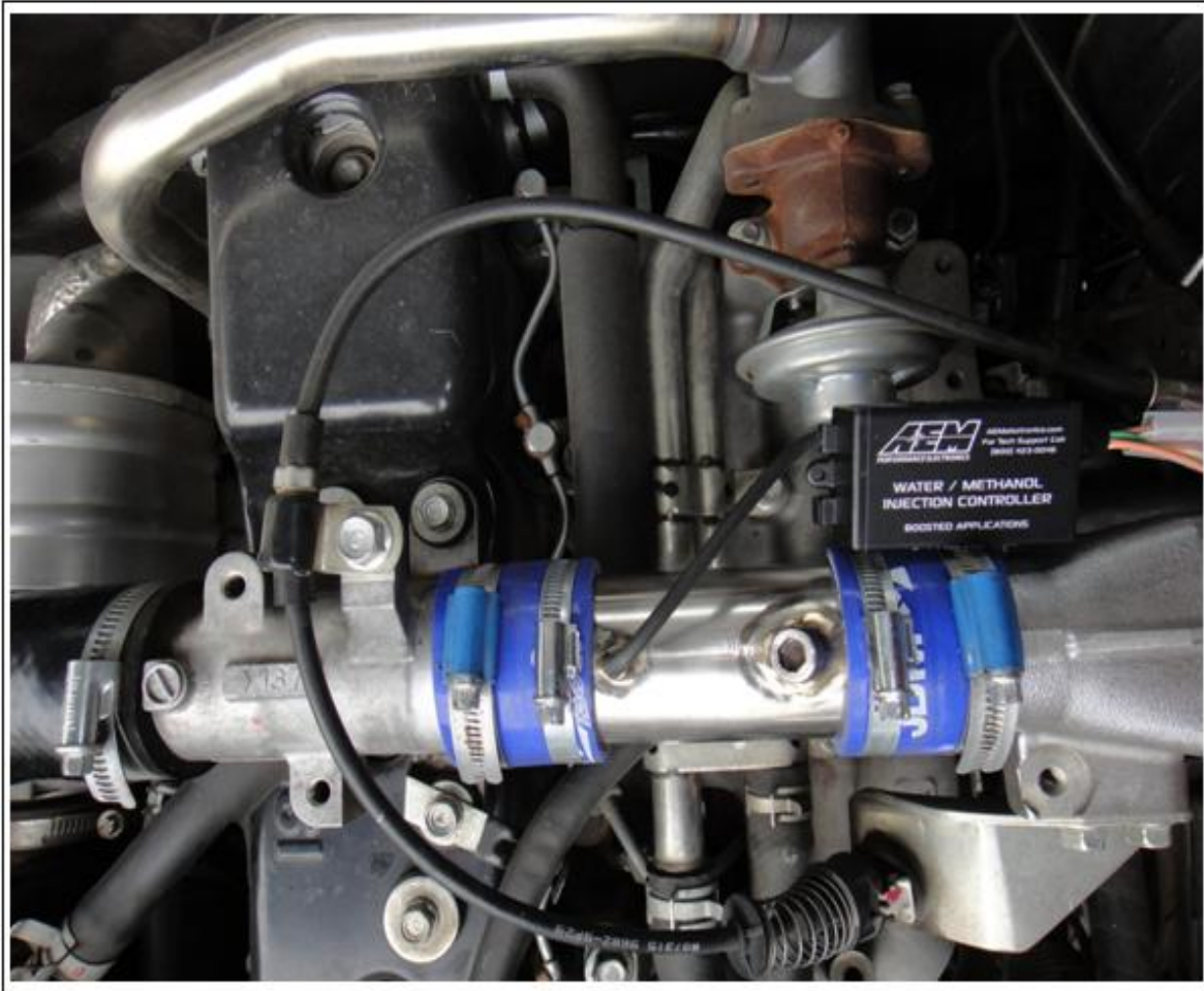
Figura. 23 Instalación de cañería, con ángulo de inyección 45°.
