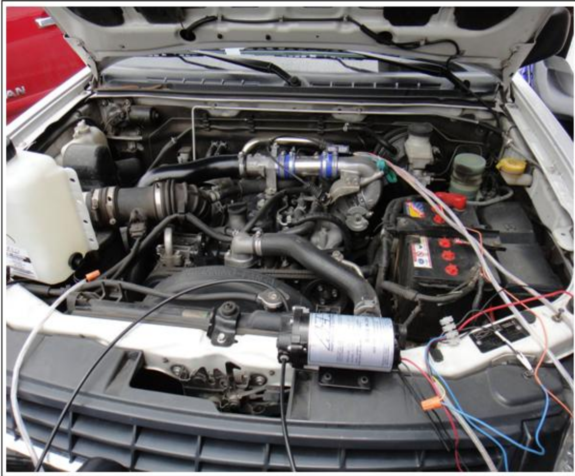
Figura. 24 Prueba de presión de aire enviada desde la manguera de vacío por la tubería de admisión hacia la computadora AEM.
