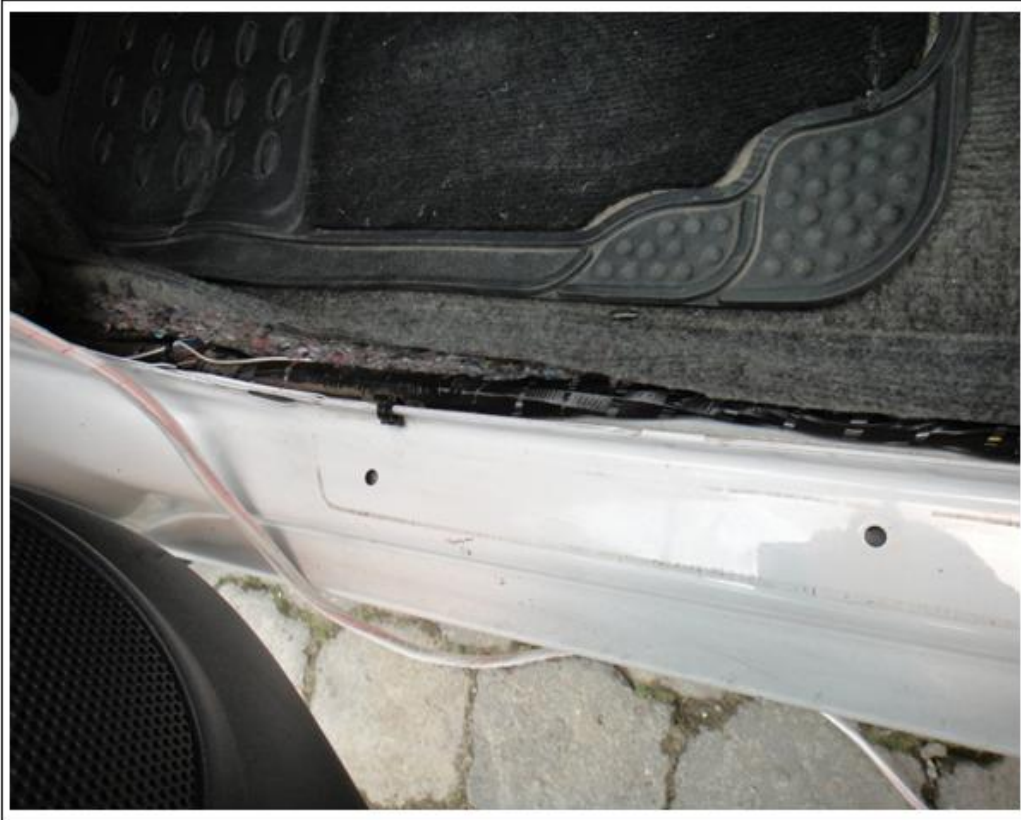
Figura. 33 Ubicación del cableado del sistema.
