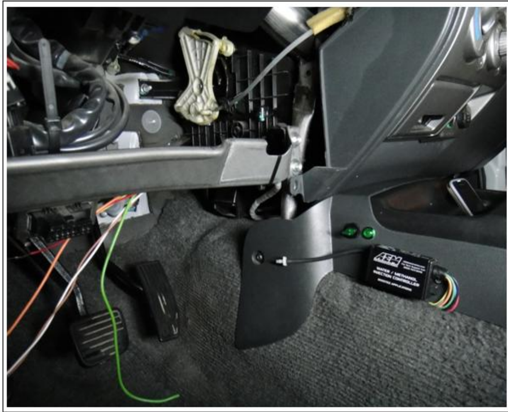
Figura. 32 Ubicación e instalación del switch de encendido, led de errores y la computadora.
