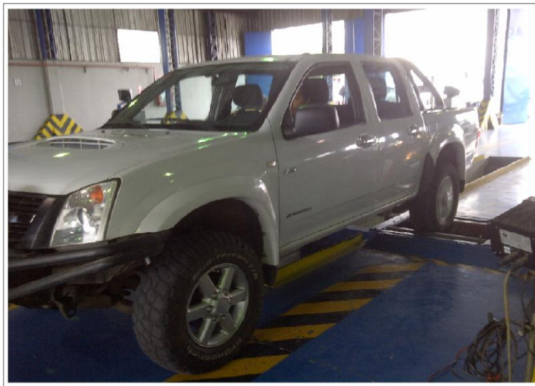
Figura. 36 Pruebas en el Dinamómetro Chevrolet Dmax 3.0 turbo diesel sin sistema adicional.
