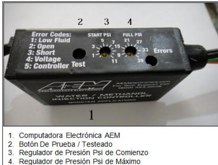
Figura. 20 Computadora Electrónica de Control de Inyección Agua/Metanol AEM.
