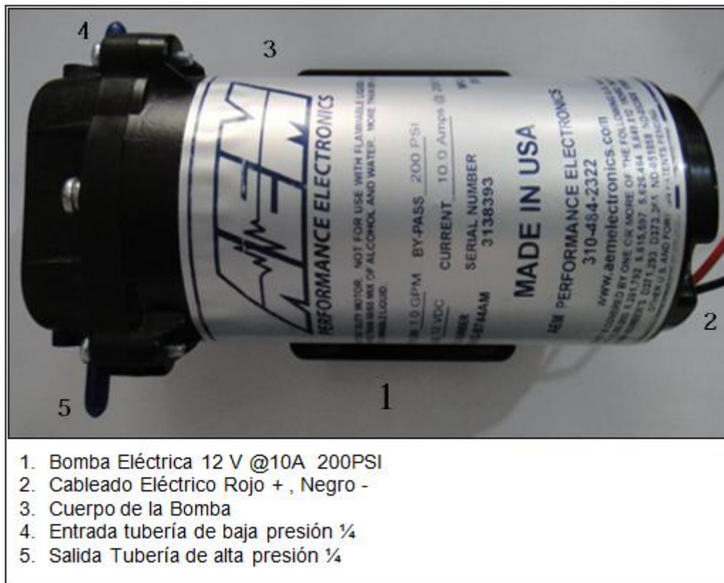
Figura. 22 Bomba Eléctrica de Inyección AEM de 12 VDC, @10 A 200 PSI.
