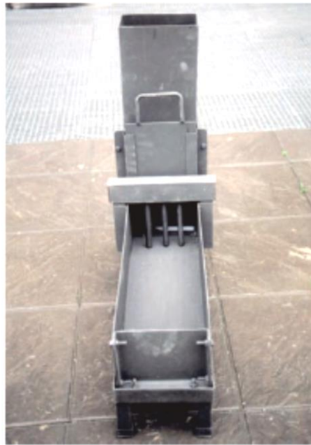
Fotografía 5 - Ensayos en estado fresco: Caja en L
