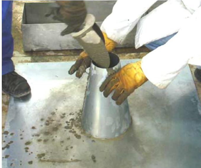
Fotografía 1 - Ensayos en estado fresco: Extensión de flujo - llenado del cono de Abrams
