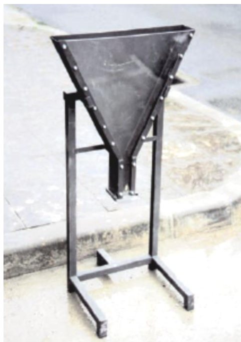
Fotografía 4 - Ensayos en estado fresco: Extensión de flujo - Embudo en V
