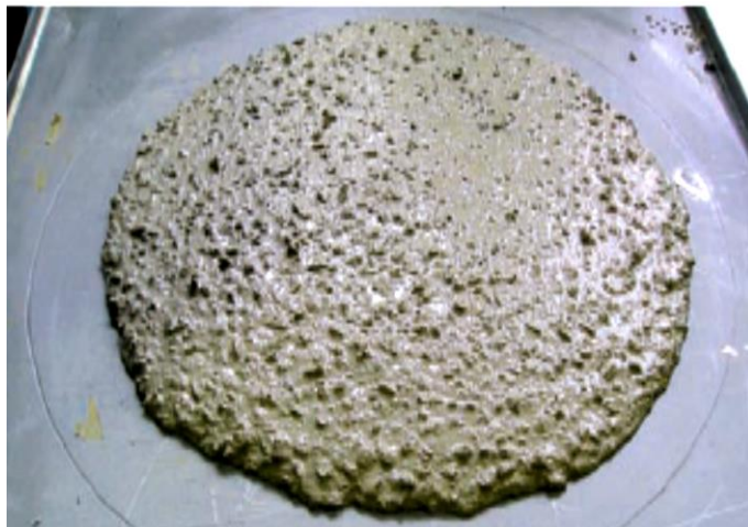
Fotografía 2 - Ensayos en estado fresco: Extensión de flujo - Extensión final del hormigón
