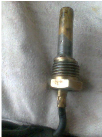
Gráfico No.- 3.19 Interruptor del electro ventilador (Foto: Rubén Arévalo)
