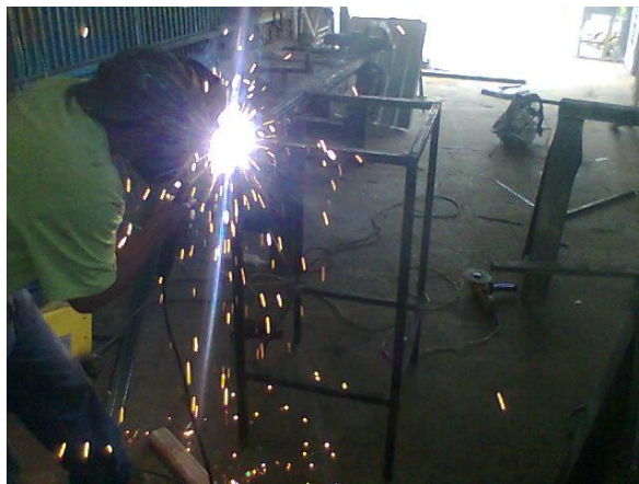
Gráfico No.- 3.7 Suelda de ruedas de apoyo a la base (Foto: Rubén Arévalo)
