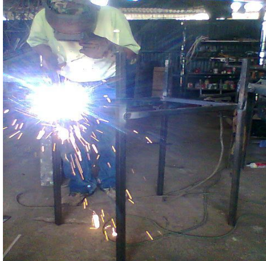
Gráfico No.- 3.6 Suelda de Bases U para los tanques (Foto: Rubén Arévalo)
