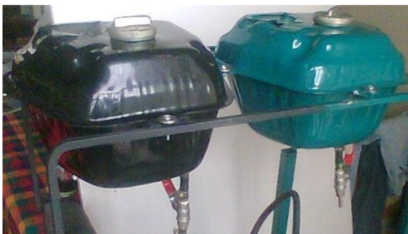
Gráfico No.- 3.17 Tanques con válvulas de dosificación (Foto: Rubén Arévalo)
