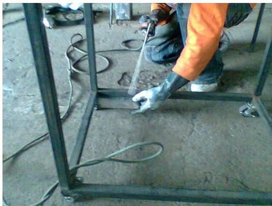
Gráfico No.- 3.9 Soporte para la batería del sistema (Foto: Rubén Arévalo)
