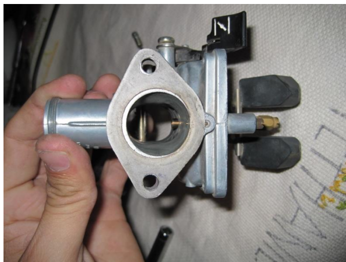
Gráfico No.- 2.6 Aleta de aceleración totalmente abierta (Foto: Rubén Arévalo)
