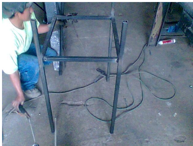
Gráfico No.- 3.4 Estructura banco del motor (Foto: Rubén Arévalo)
