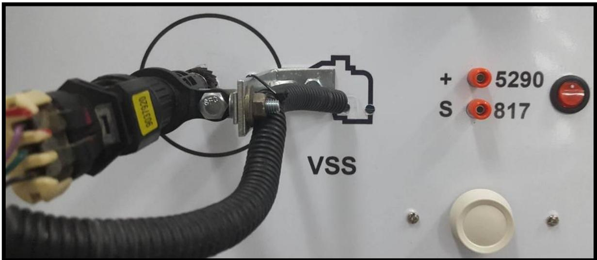
**Figura 7.** Sensor de velocidad del vehículo (VSS)
