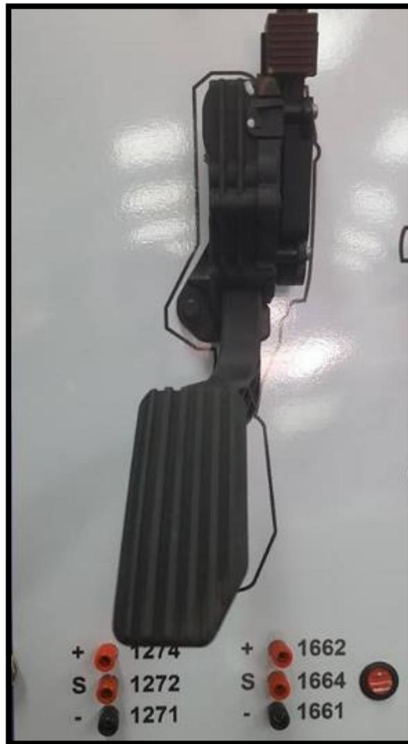
**Figura 30. Pedal de aceleración**
