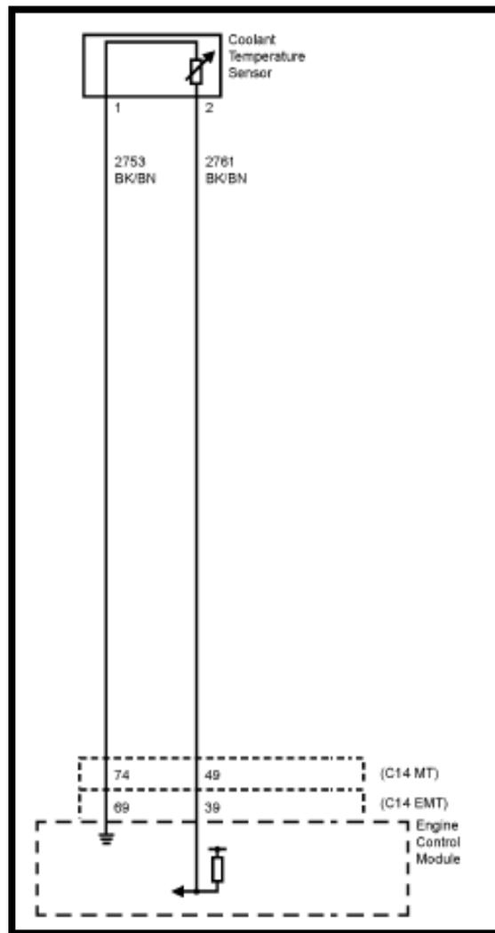
Figura 40. Diagrama eléctrico del sensor ECT
