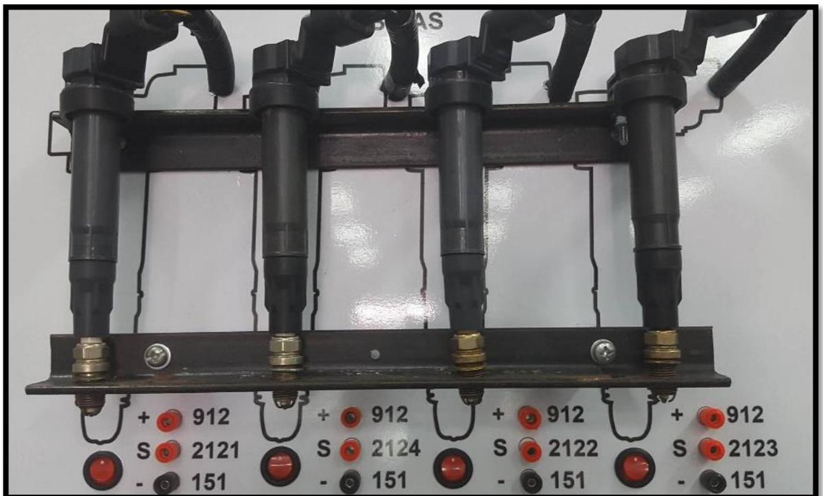
**Figura 26. Bobina de encendido**
