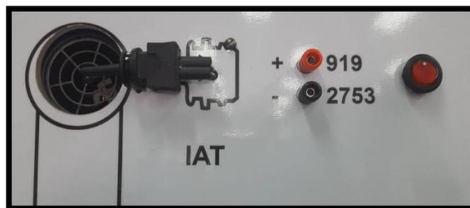
Figura 11. Sensor de temperatura del aire de admisión
