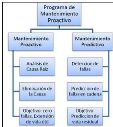
Figura N° 1.4 Mantenimiento proactivo Fuente: GARCIA GARRIDO, Santiago, ORGANIZACIÓN Y GESTIÓN INTEGRAL DE MANTENIMIENTO
