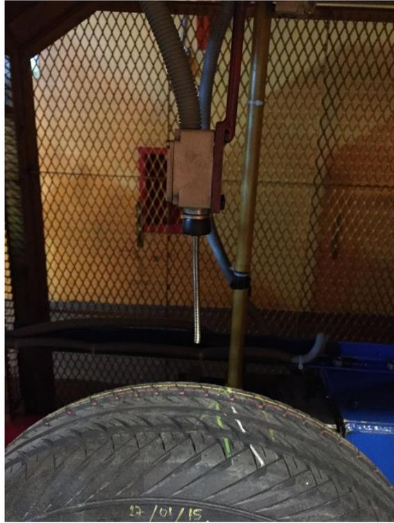
**Sensor de posición del neumático**
