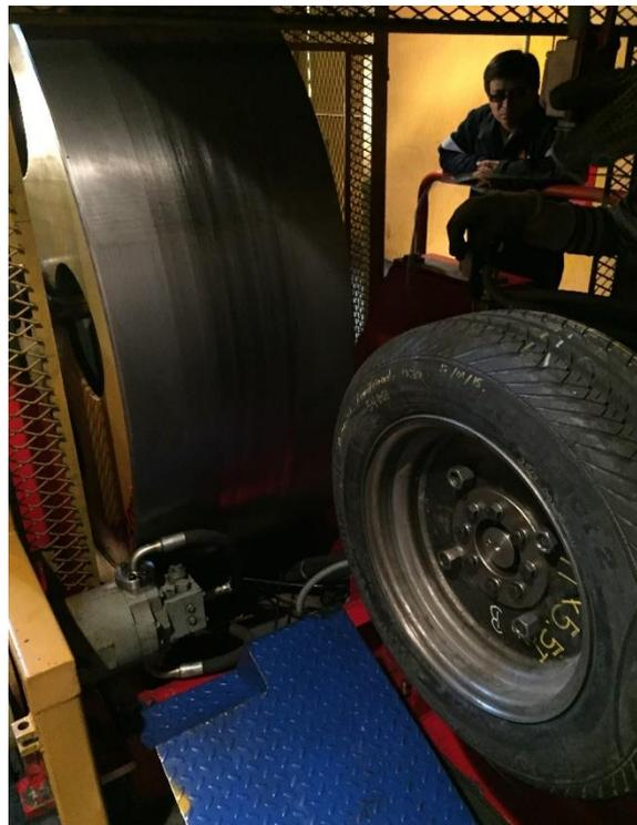
**Asentamiento de la rueda plana de acero sobre el neumático Kumho**
