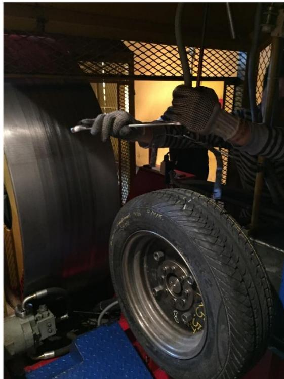
**Ajuste del sensor de posición del neumático**
