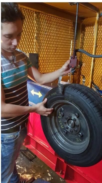
**Colocación del neumático sobre la rueda plana de acero**
