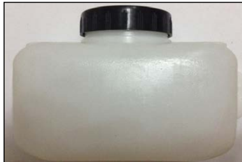
Figura 18. Depósito de Expansión
