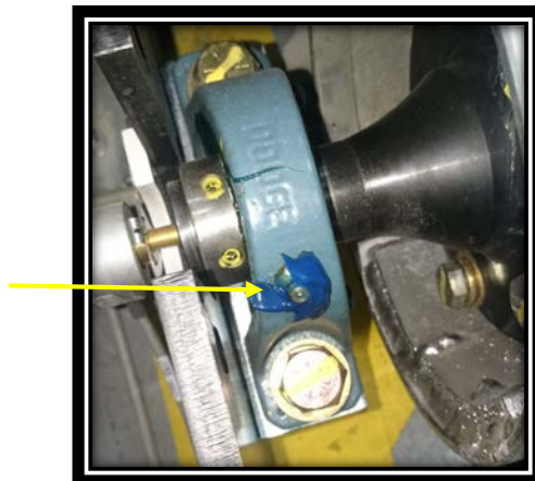
Figura 14. Rodamiento engrasado del dinamómetro X 2WD
