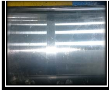
Figura 6. Rodillo con superficie lisa del dinamómetro X 2WD
