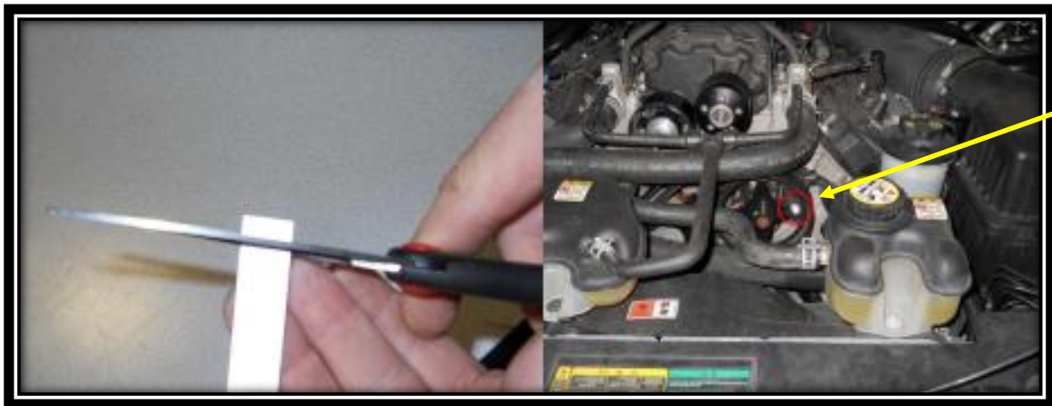
Figura 42. Banda reflexiva y su colocación
