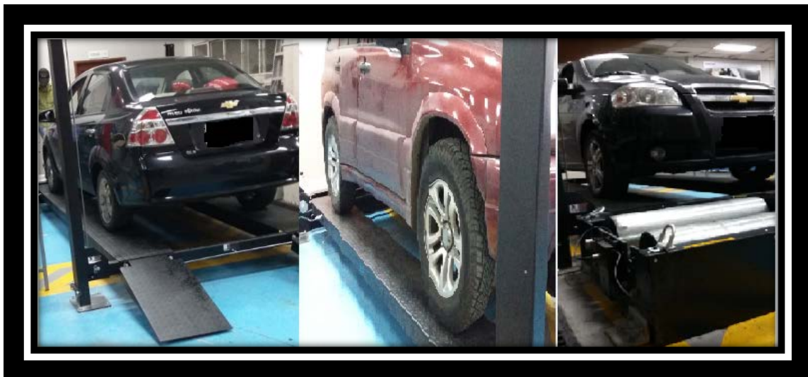
Figura 12. Alineación de vehículo en rampa.
