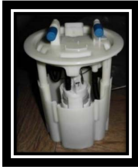
Figura 6. Bomba de combustible.
