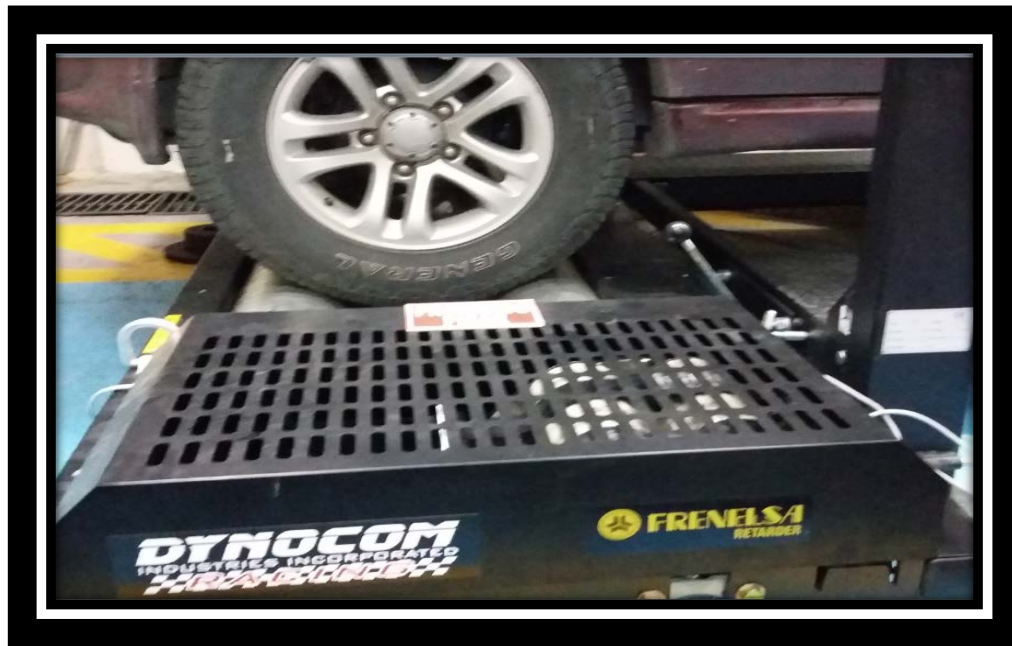
Figura 13. Rodillos frenos para ubicar ruedas de vehículo.
