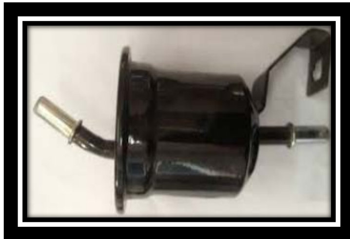
Figura 7. Filtro de combustible.
