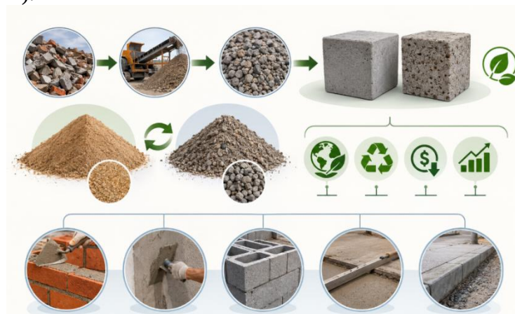
Figura 14. Sustitución de arena por agregado reciclado.
