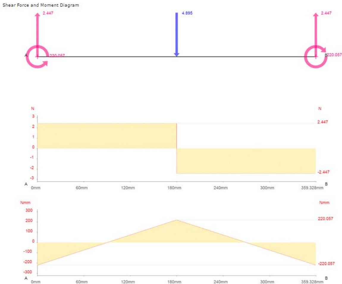
Figura 3.11: Diagrama de cuerpo libre, esfuerzo flexionante y momento cortante.
