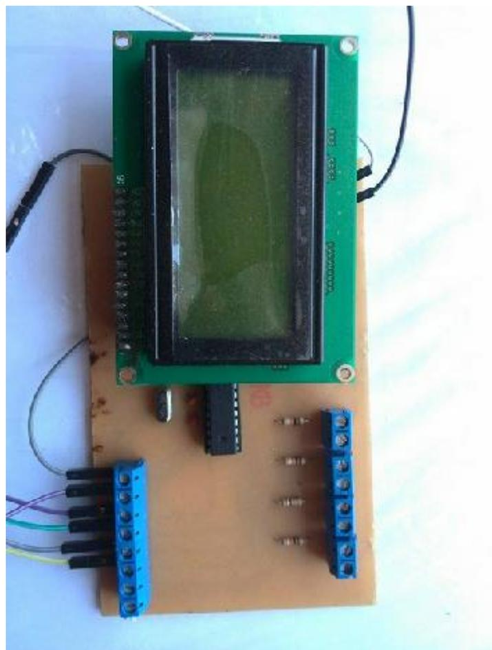
Figura 3.22: Placa para ATmega 328P con elementos
