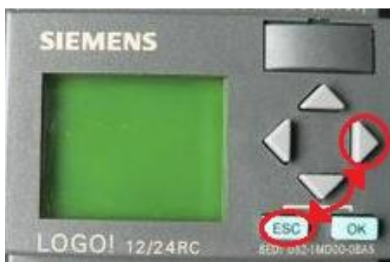
Figura 3.39: Ingreso a modo de soldadura.
