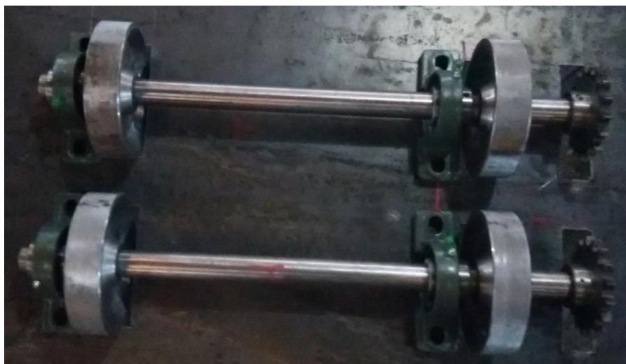
Figura 4.6: Eje principal del movimiento
