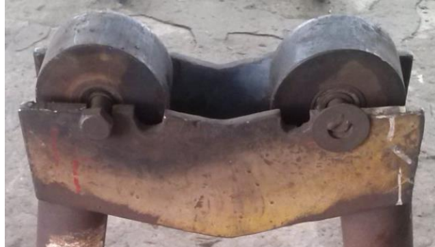
Figura 1.5: Garruchas para sujeción y movimiento de herramientas tubulares en Weatherford
