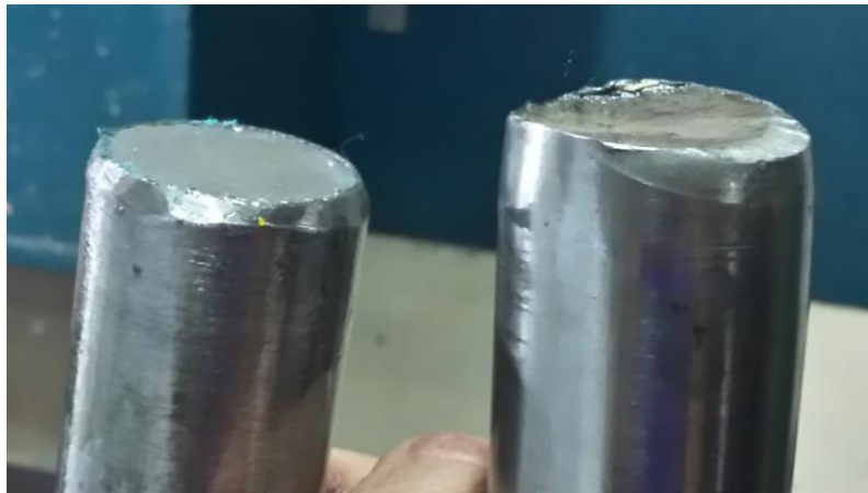
Figura 4.2: Deformación de la punta del eje
