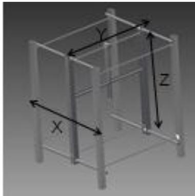
Figura 2.8. Modelado del robot cartesiano.
