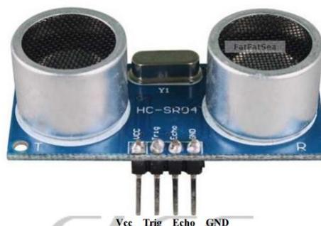
Figura 3.30. Configuración de pines del Sensor ultrasónico HC-SR04 adaptada de [32].
