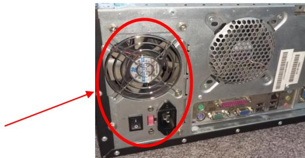
Figura 1.15. Fotografía de la fuente de poder con polvo en su ventilador.
