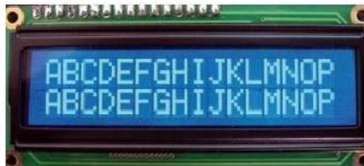
Figura 3.31. Fotografía del LCD 16x2.
