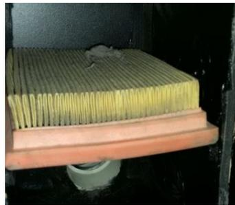
Figura 4.14. Fotografía del filtro de aire con pelusas removidas en la limpieza de un case.
