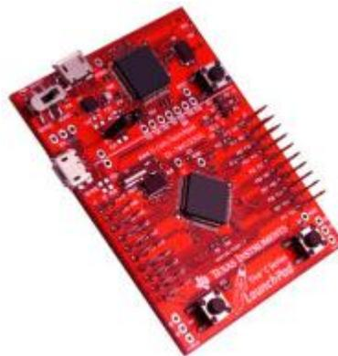
Figura 2.12. Módulo Texas Instruments Tiva C Series TM4C123G adaptada de [24].
