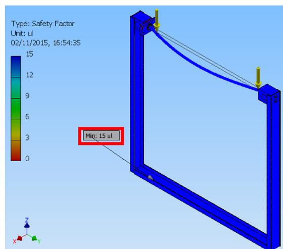
Figura 3.18. Factor de seguridad de la estructura del movimiento en Z.
