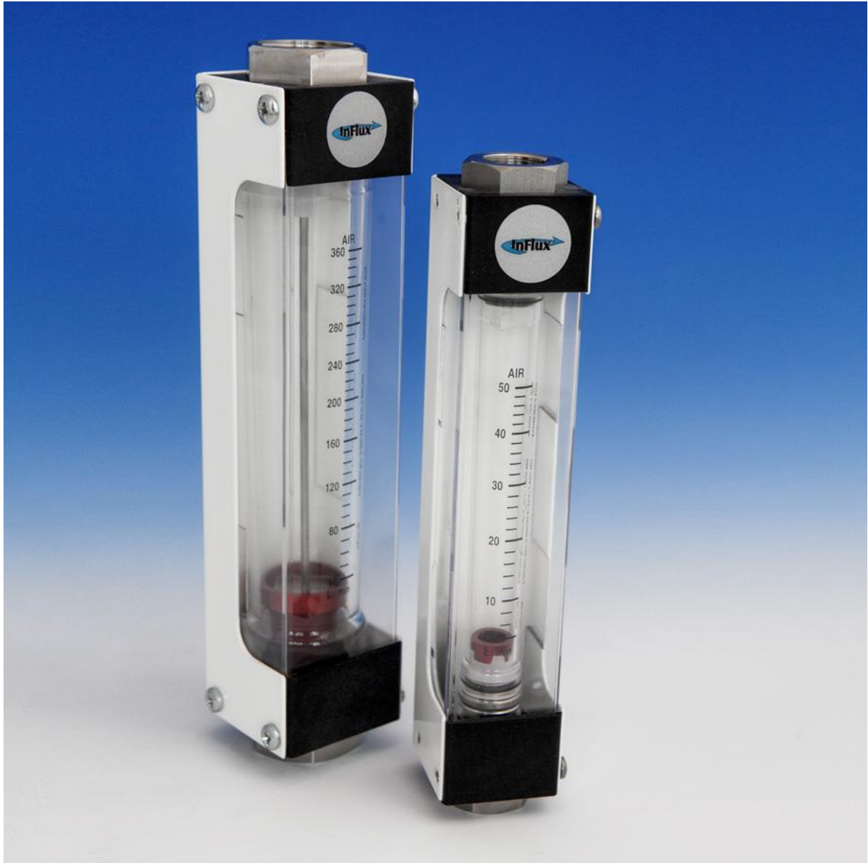
Figura Q.3. Rotámetros empleados para la medición de caudal.
