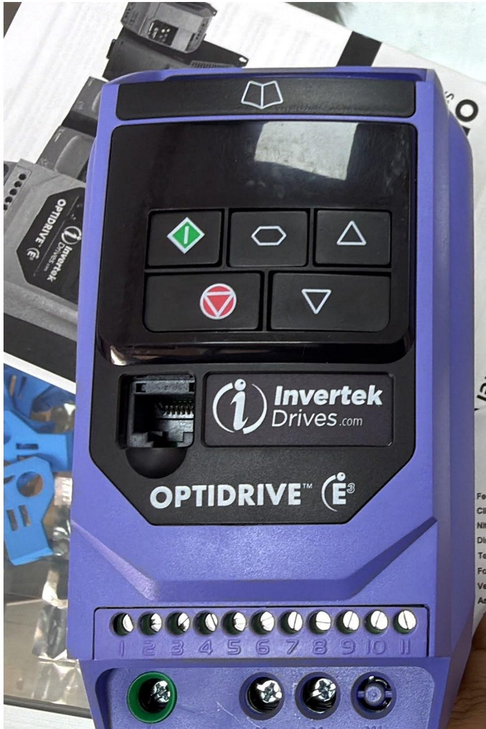
Figura U.1. Variador de frecuencia Optidrive E3 empleado para controlar la velocidad de la bomba.
