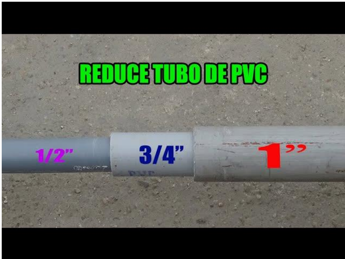
Figura AB.1. Comparación visual de diámetros de tubería PVC, incluyendo 1/2 y 3/4 pulgadas.
