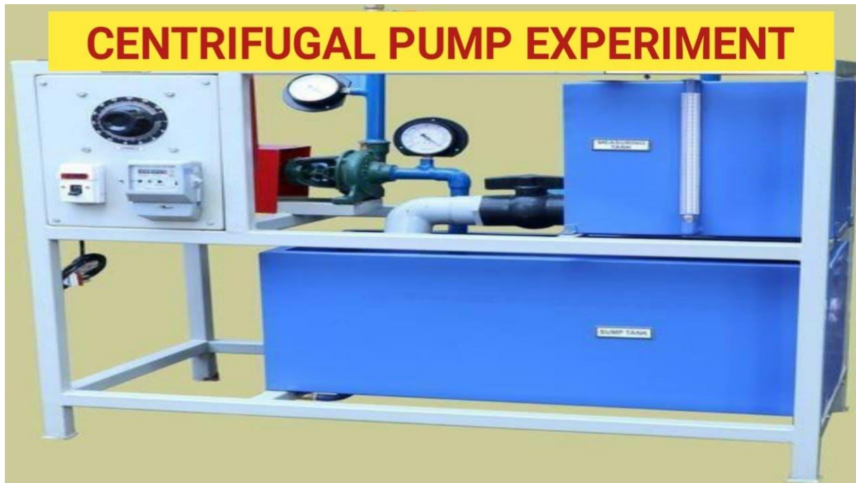
Figura H.3. Banco experimental con bomba centrífuga.
