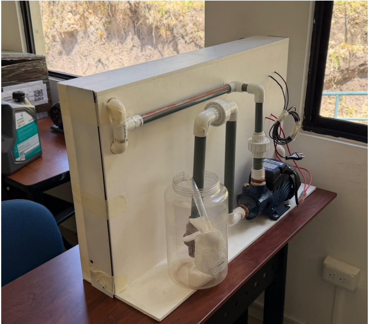
Figura T.1. Vista posterior del banco de pruebas hidráulico con depósito, bomba y sistema de tuberías.
