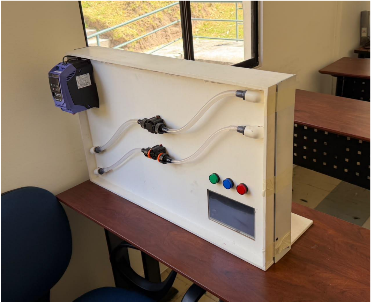
Figura S.1. Vista frontal del banco de pruebas hidráulico con sensores de caudal y panel de control.
