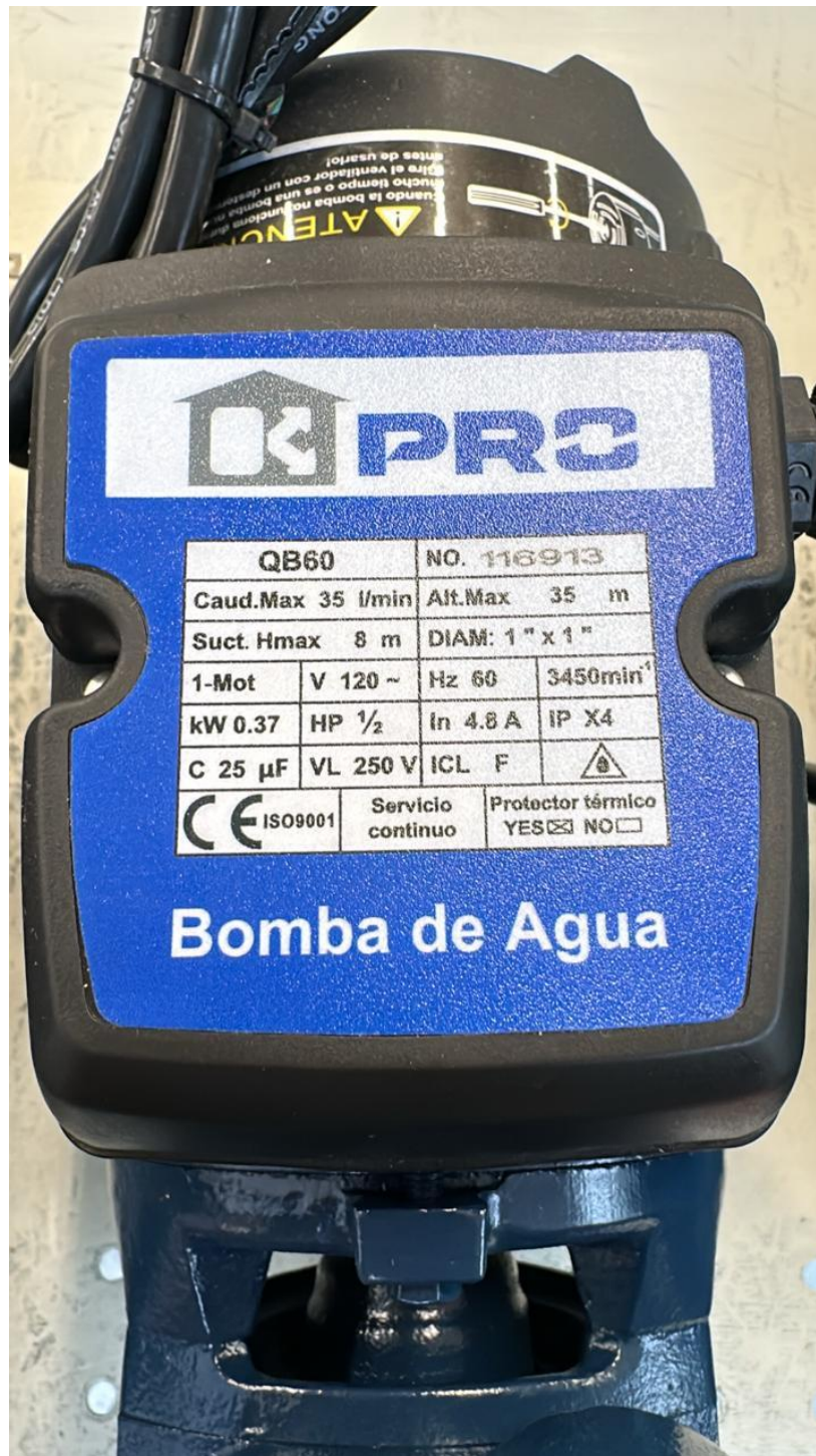
Figura V.1. Placa de características técnicas de la bomba de agua QB60.
