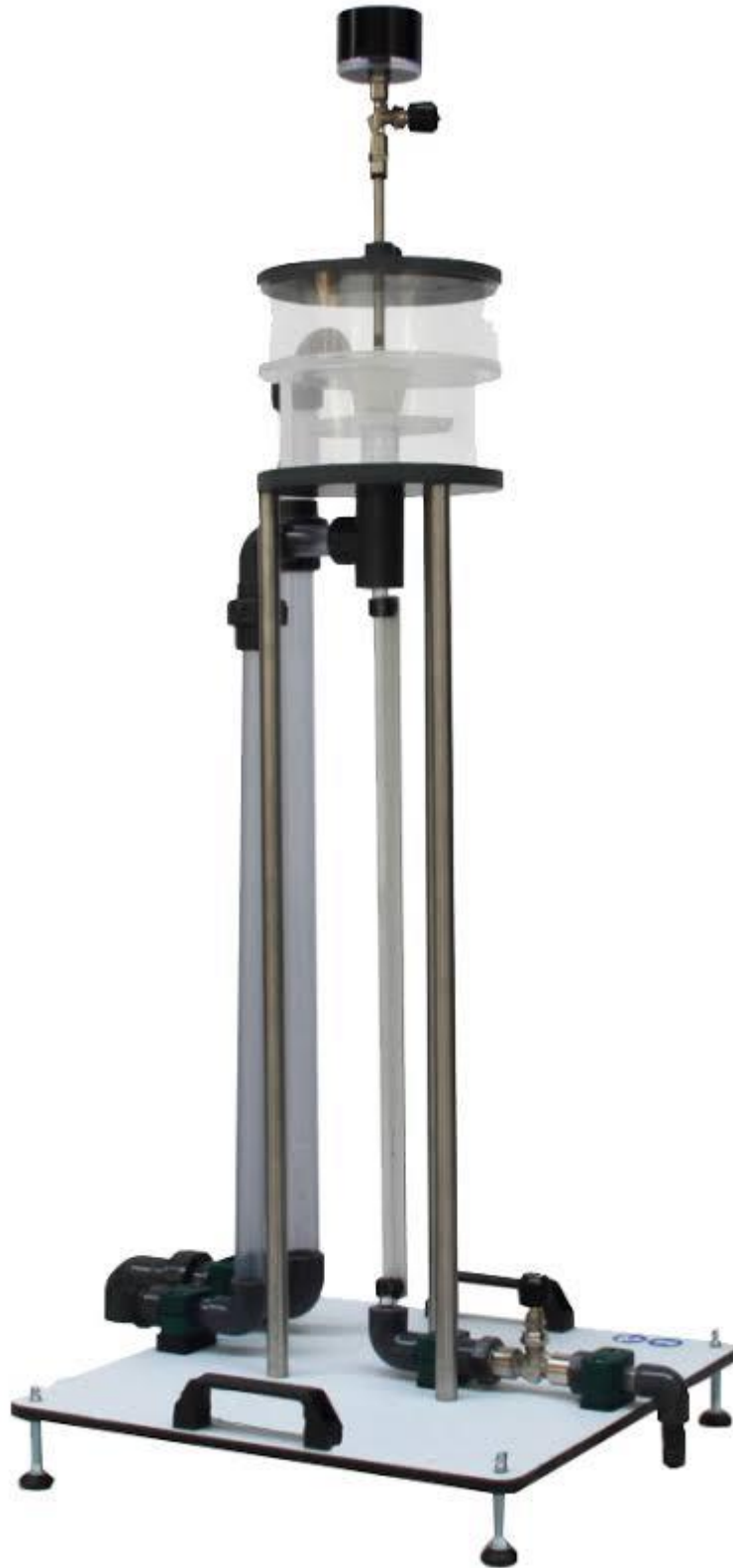
Figura R.5. Equipo experimental para el estudio del número de Reynolds y los regímenes de flujo.
