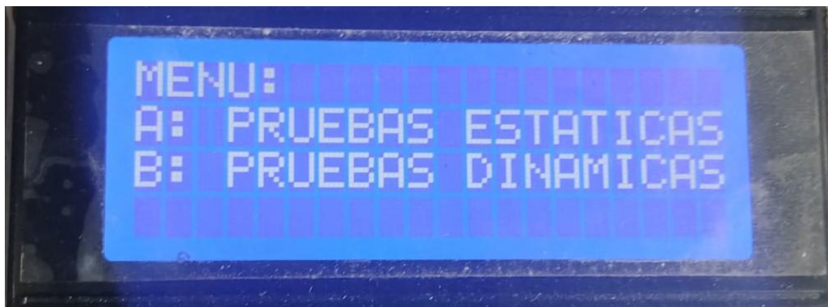
figura 5 Display de monitoreo LCD 20x4 para adquisición de datos en tiempo real
