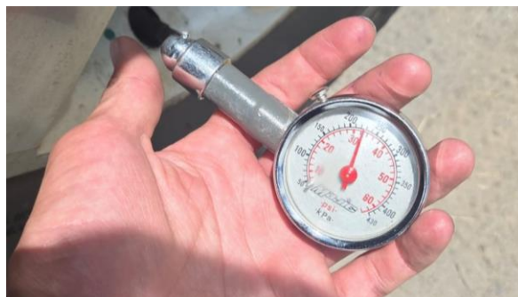
Gráfica 5: Manómetro de presión
