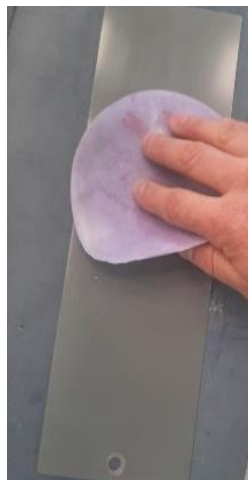
Lijado del área de aplicación
