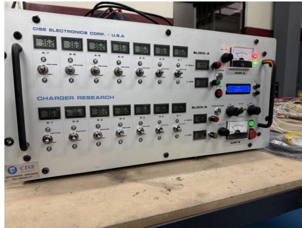
Figura 43 Equipo Charger Research utilizado para el balanceo de celdas
