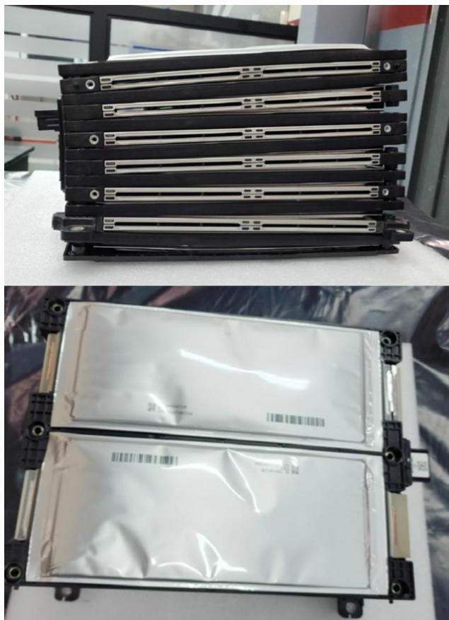
Figura 48 Módulos de baterías de ion-litio utilizados en las pruebas experimentales
