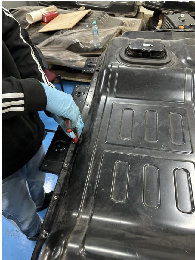
Figura 36 Desmontaje de la carcasa de la batería Kia Soul EV.
