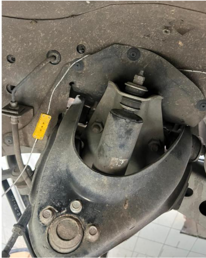
ANEXO 6: Colocación del guardapolvo
