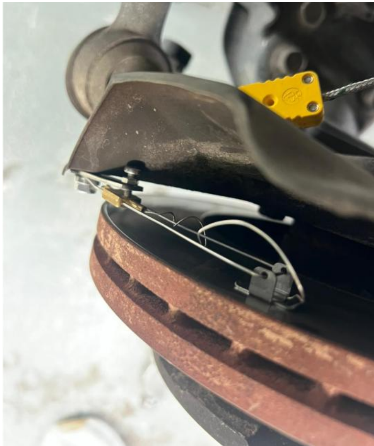
ANEXO 8: Ubicación de la termocupla junto al disco
