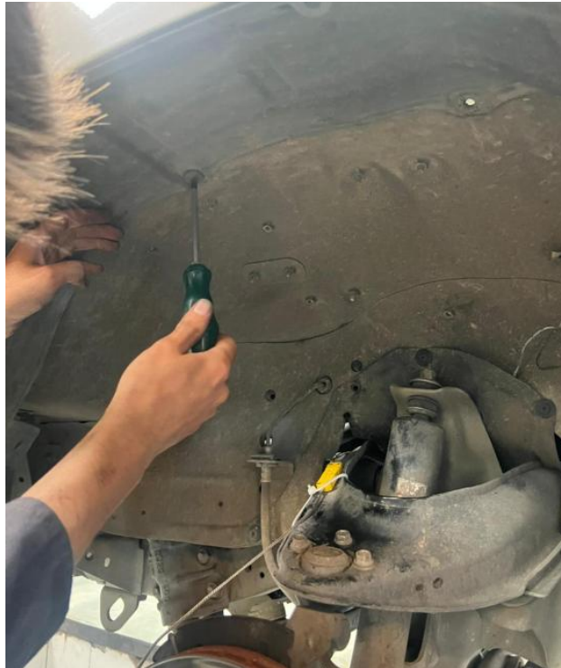
ANEXO 8: Ubicación de la termocupla junto al disco
