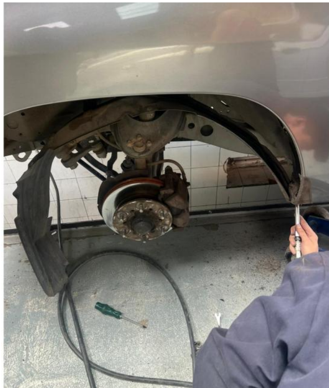
ANEXO 6: Colocación del guardapolvo
