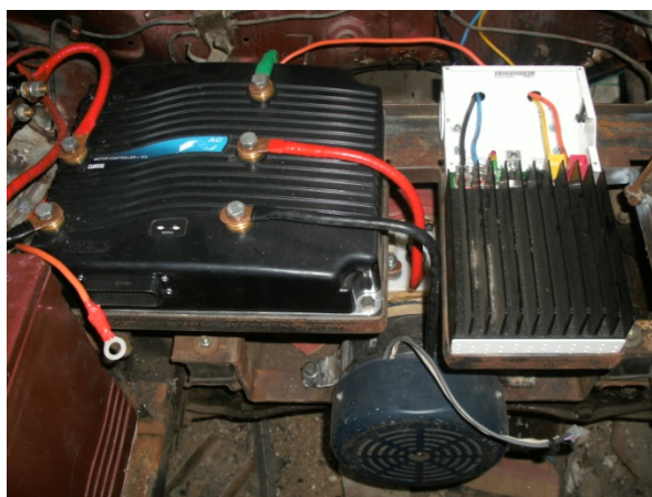
Figura 3.43 Conexiones al regulador de voltaje de los paneles
