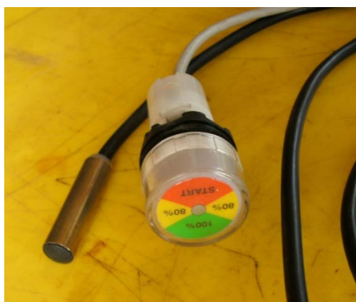
Figura 3.46 Sensor de Temperatura e indicador de carga de las baterías
