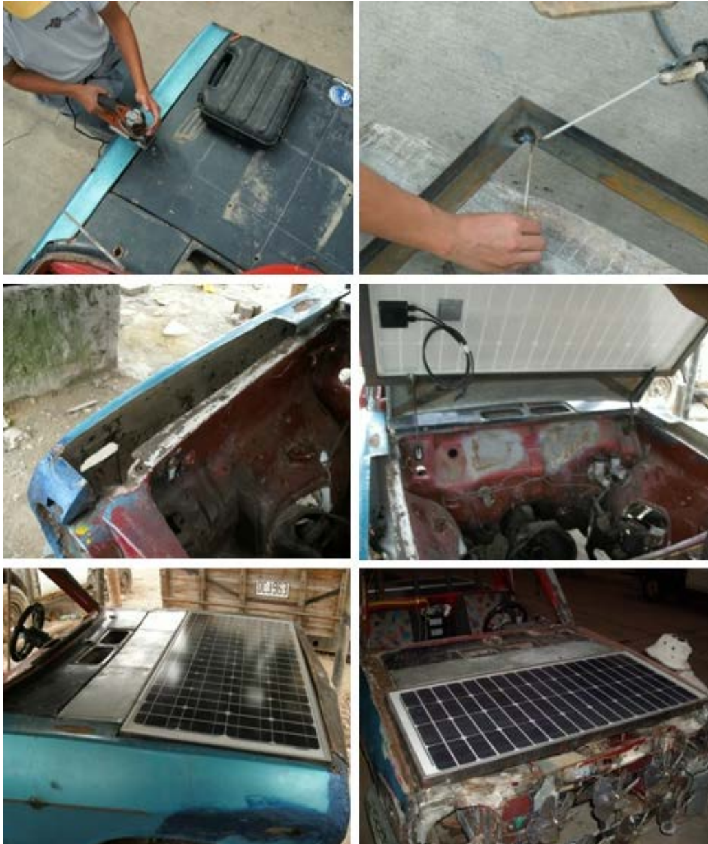
Figura 3.40 Proceso de adaptación del panel solar en el capot
