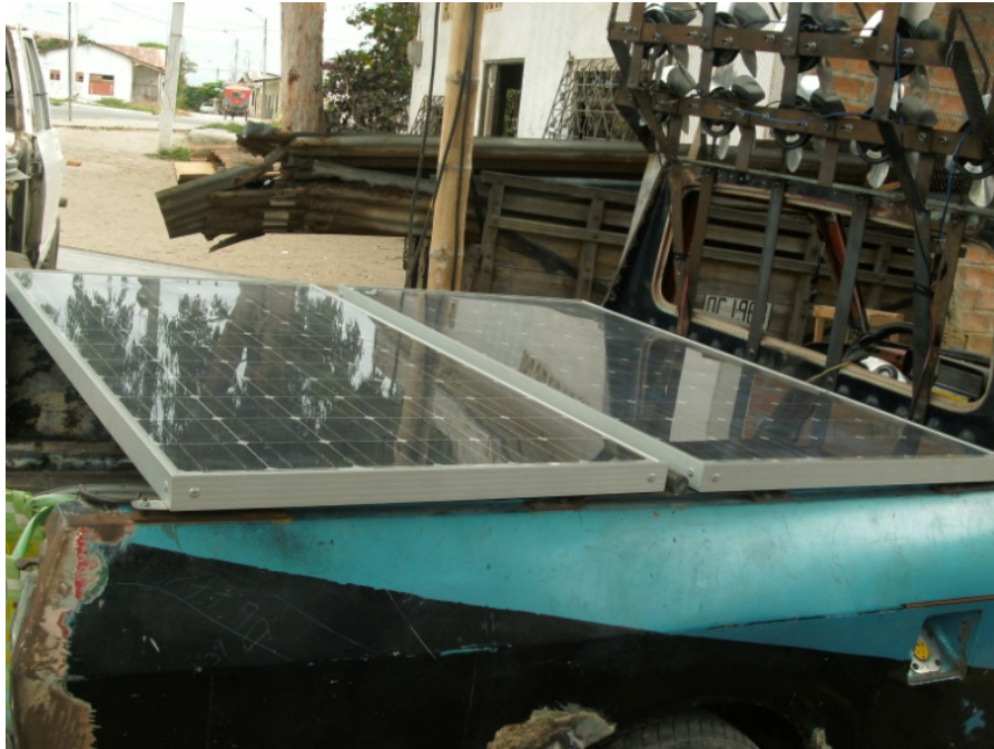
Figura 3.38 Paneles solares del balde instalados
