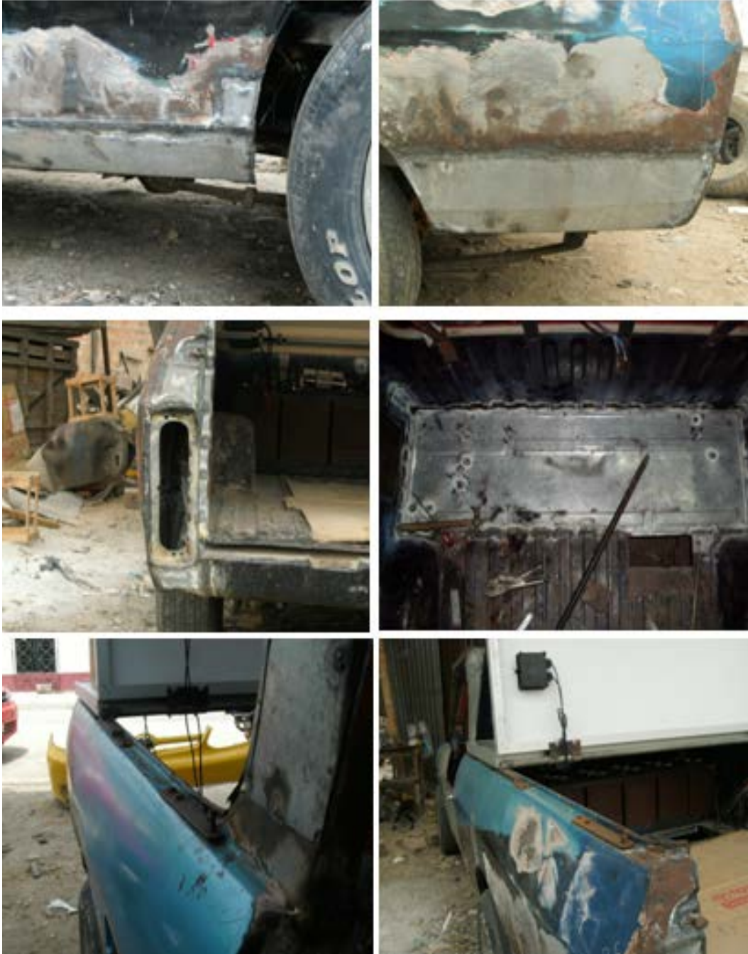
Figura 3.14 Balde reparado en los costados con lata galvanizada de 0,9 mm de espesor y puente reforzado con lata galvanizada de 1,1 mm de espesor para las baterías.
