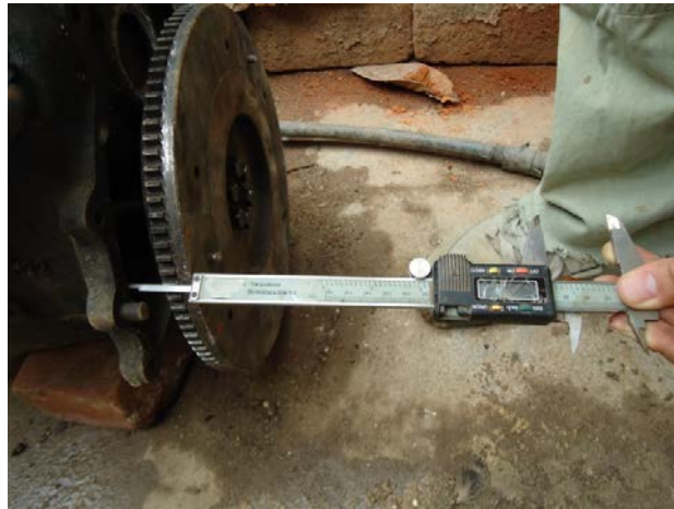
Figura 3.19 Medición de la distancia del volante motor al motor de combustión interna
