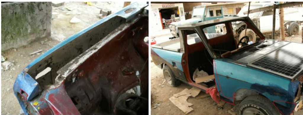
Figura 3.9 o Partes en mal estado antes de ser cambiadas.
