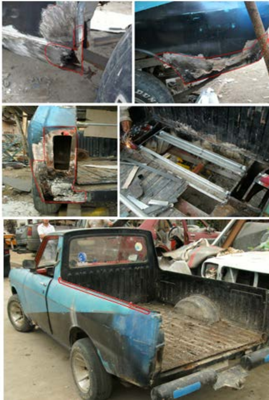
Figura 3.13 o Partes en mal estado antes de ser cambiadas y modificadas
