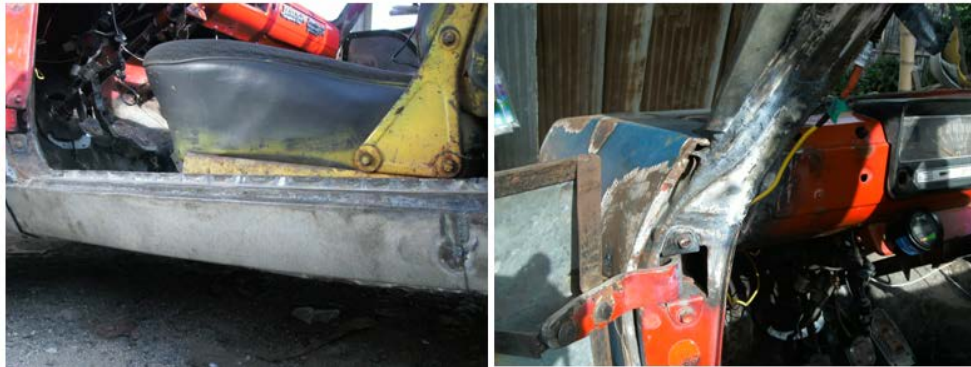
Figura 3.12 Las partes en mal estado del túnel fueron reemplazadas con lata galvanizada de 0,9 mm de espesor y el parante con lata galvanizada de 0,75 mm de espesor.
