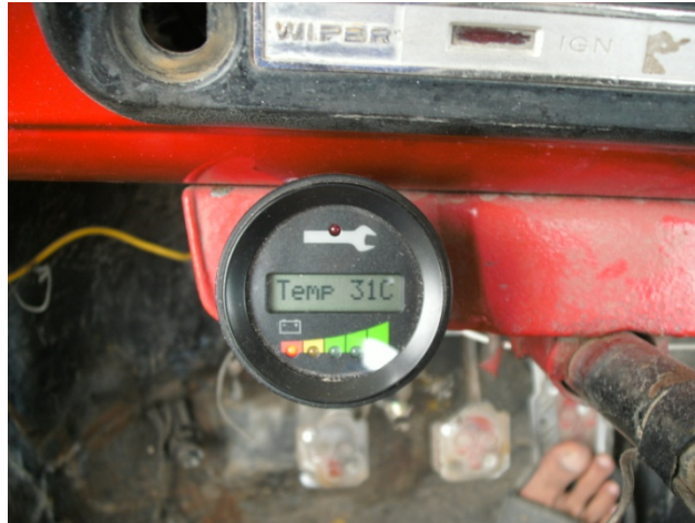
Figura 3.58 Display Curtis monitoreando la temperatura del motor
