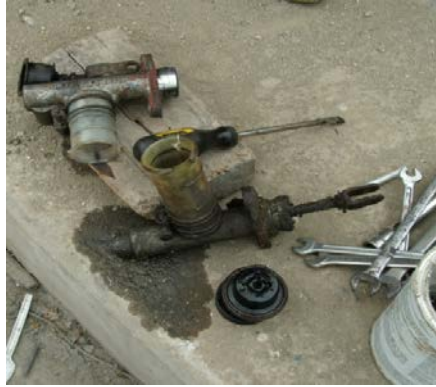
Figura 3.26 Bomba de freno en mal estado
