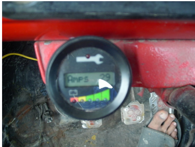
Figura 3.56 Display Curtis monitoreando el consumo de amperios del motor
