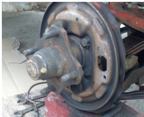
Figura 3.28 Reemplazo de cilindros y purgas en mal estado
