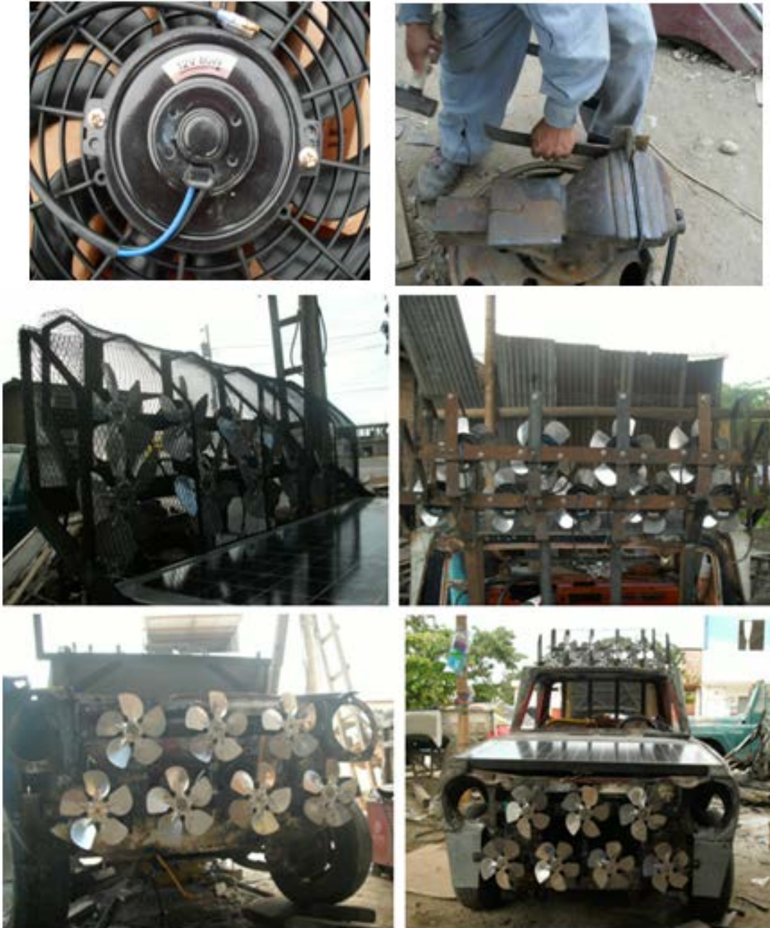
Figura 3.44 Proceso de adaptación de los generadores eólicos
