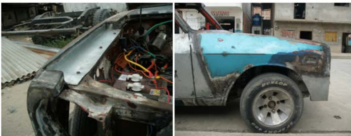
Figura 3.10 Partes arregladas con lata galvanizada de 0,9 mm de espesor en la parte posterior y 0,75 mm de espesor en la parte frontal y superior.
