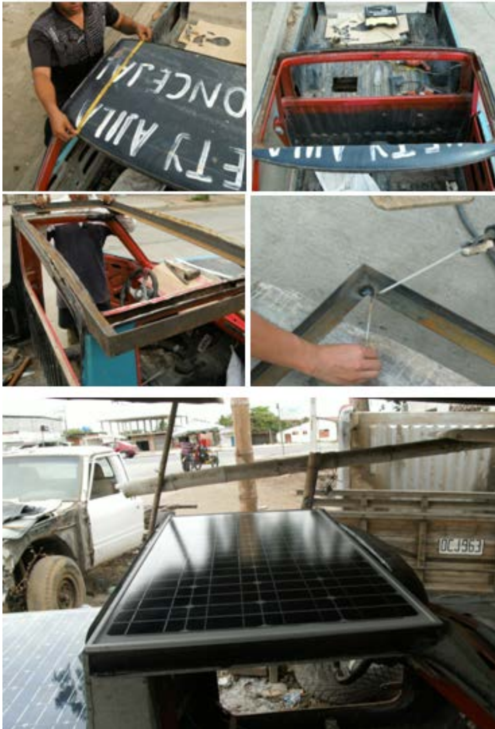
Figura 3.39 Proceso de adaptación del panel solar en el techo
