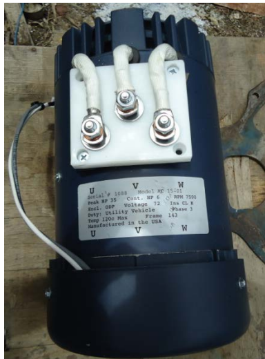
Figura 3.18 Motor eléctrico de inducción AC de 43 HP
