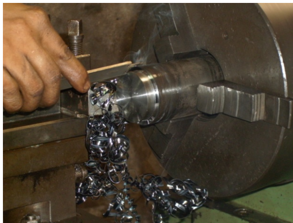
Figura 3.20 Mecanizando la pieza de acople del volante y el motor eléctrico
