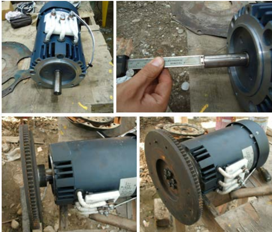
Figura 3.21 Volante motor y motor eléctrico unidos mediante el acople de acero de transmisión
