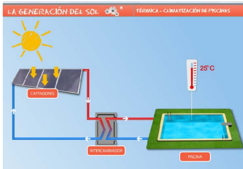
Figura 1.5. Esquema de un sistema solar térmico de una piscina. 5
