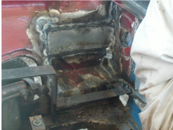
Figura 3.51 Soporte de las baterías en la parte delantera.
