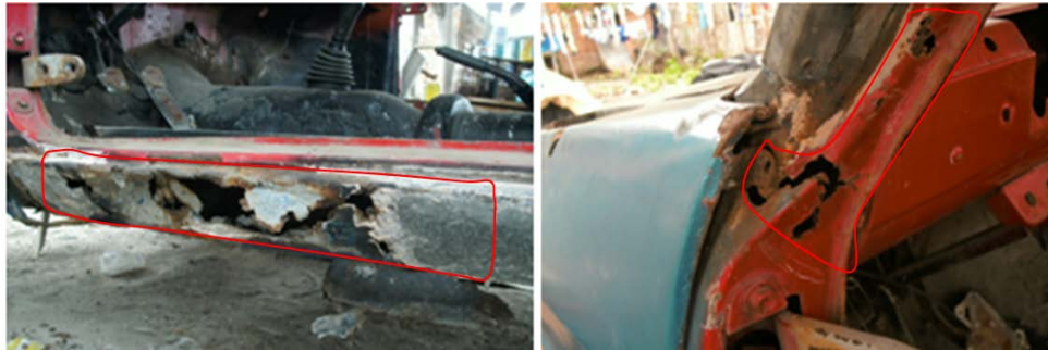
Figura 3.11 Partes en mal estado antes de ser cambiadas.
