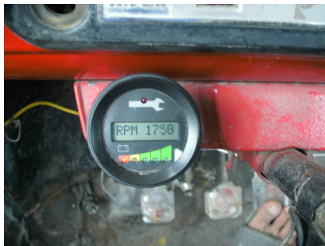
Figura 3.57 Display Curtis monitoreando el numero de revoluciones del motor
