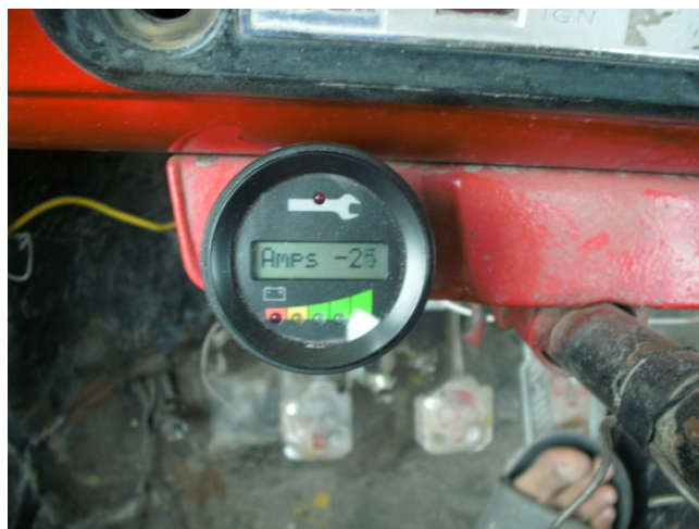
Figura 3.59 Display Curtis monitoreando la generación de electricidad
