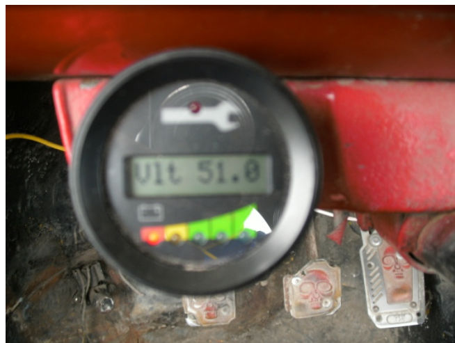
Figura 3.54 Display Curtis monitoreando voltaje de baterías
