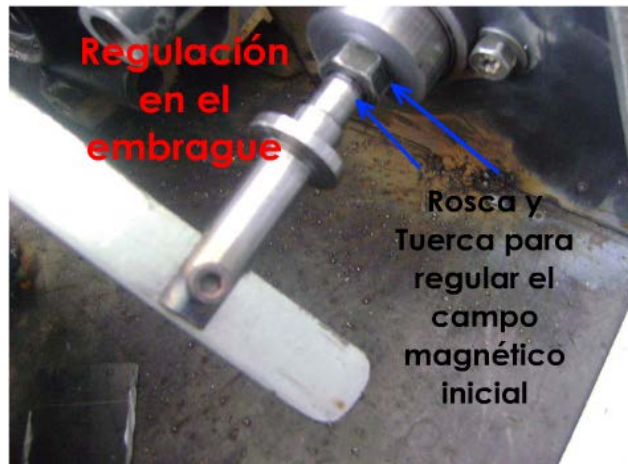
Fig. 4.9: Regulación del embrague
