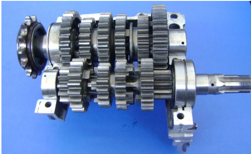
Fig.4.1: Caja de cambios en corte
