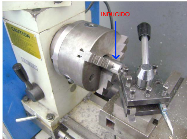
Fig. 4.3: Construcción de los inducido
