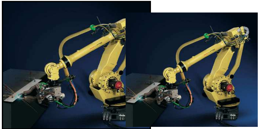
Figura Nº2. 131212 Soldadura por puntos
