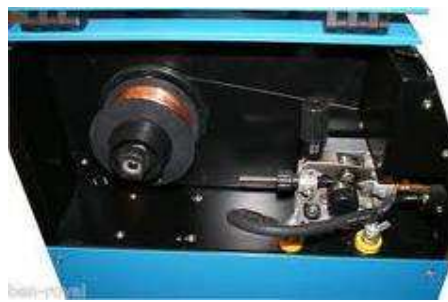
Figura N°3. 666 Unidad alimentadora de hilo
