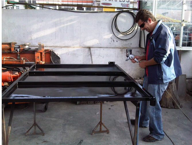
Figura N°4. 161616 Proceso de pintura
