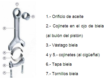
Gráfico 3.9 Componentes del brazo de biela
