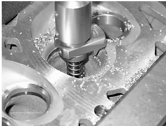
Gráfico 3.13 Rectificado del asiento de válvula
