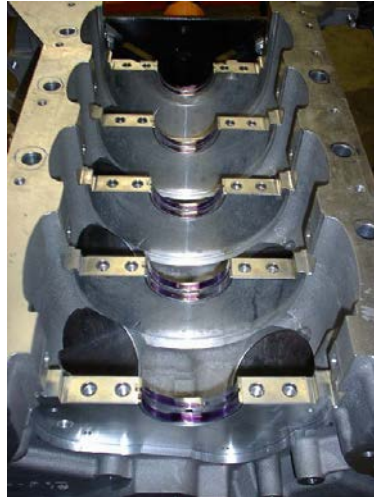
Gráfico 3.7 El túnel de bancadas
