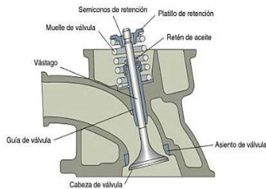
Gráfico 3.12. Componentes de la válvula
