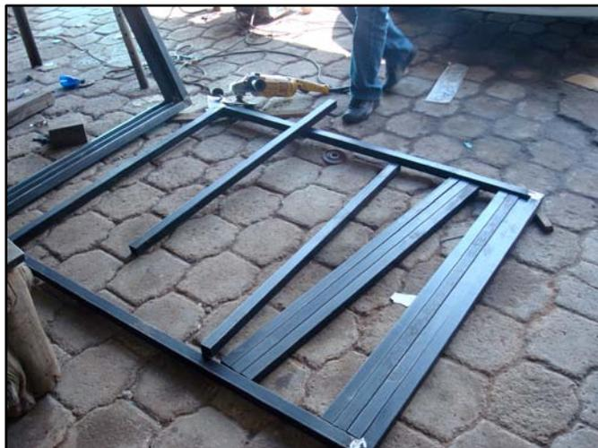
Se usó la amoladora con un disco para el corte de los tubos cuadrados de hierro para la estructura.
