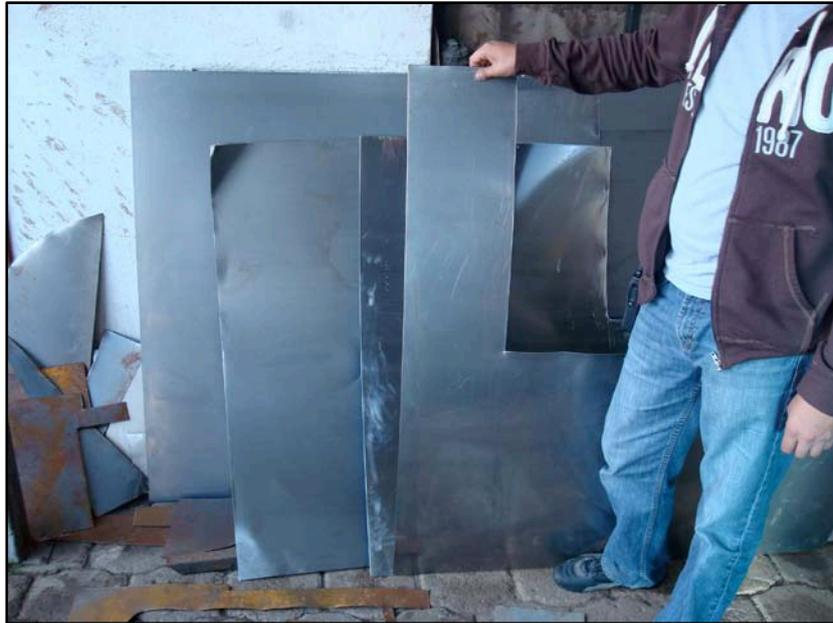
Planchas de tool utilizadas en las divisiones, utilizamos la amoladora con un disco de corte para obtener el tamaño necesario.
