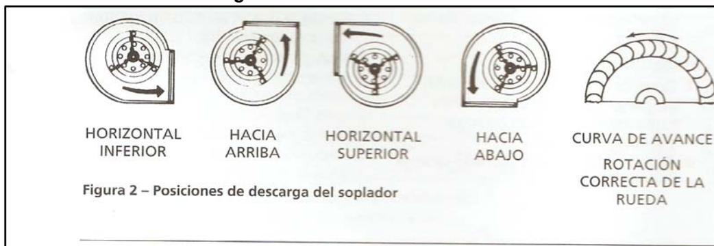
El extractor seleccionado tiene dos aplicaciones, como soplador de accionamiento directo o extractor, se lo puede colocar de distintas posiciones según las necesidades.
