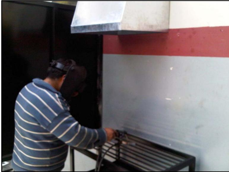
Realizamos una prueba con los 2 equipos funcionando para verificar que no haya una caída de tensión, la cual pueda hacer que el breaker salte de su posición On a Off.
