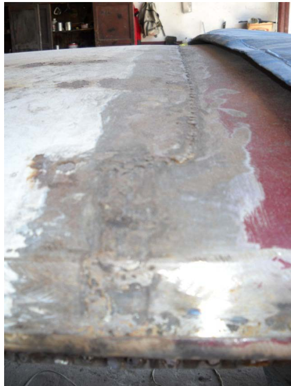
Gráfico 102 Pulido de techo Volvo 244GL
