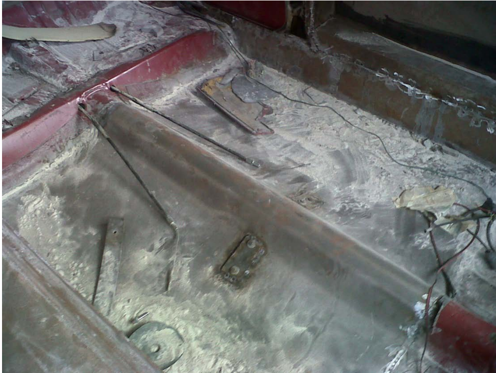
Gráfico 135 Proceso de soldado y pulido de piso en extensión
