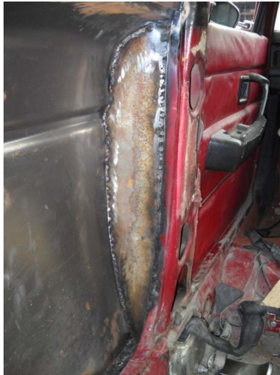
Gráfico 123 Soldado de piezas (Extensión de carrocería) #1
