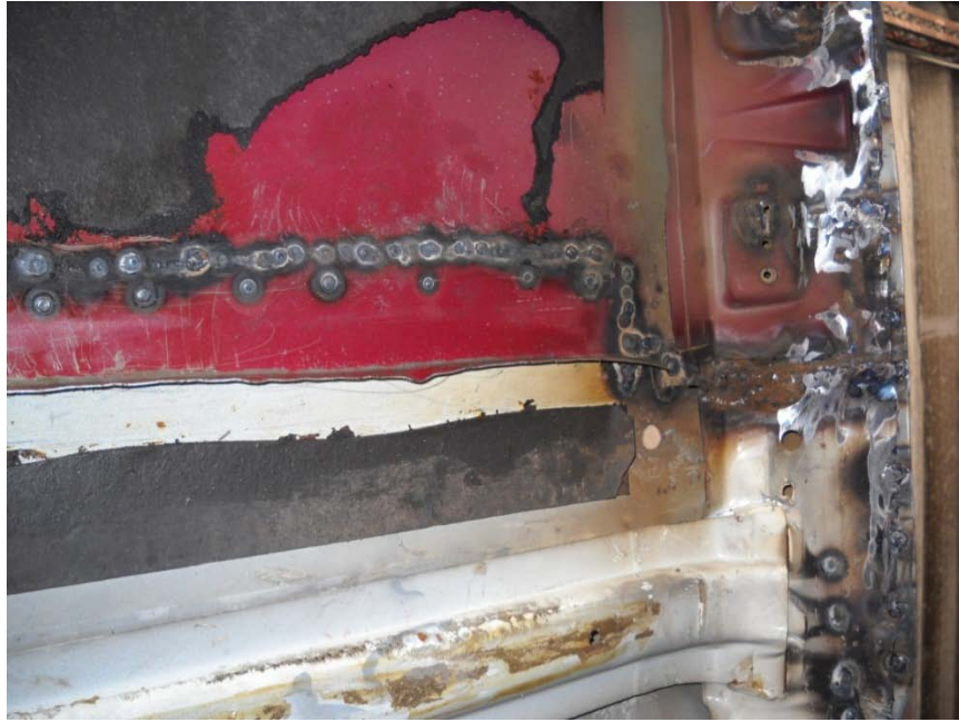
Gráfico 95 Soldado y pulido de carrocería
