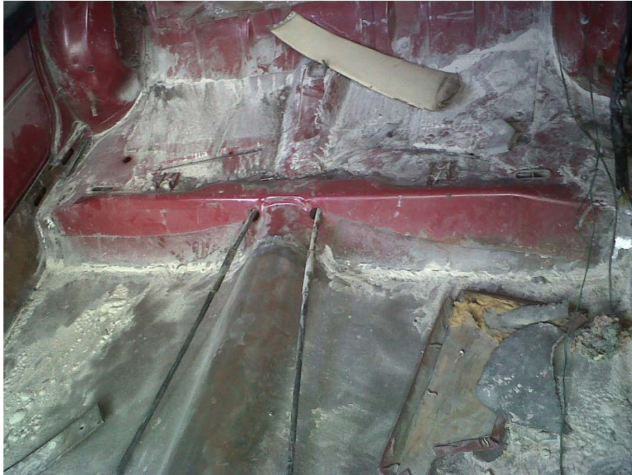
Gráfico 133 Proceso de soldado de piso en extensión #1
