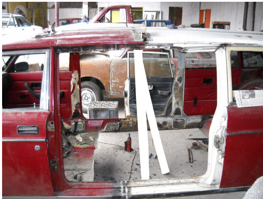
Gráfico 76 Alargamiento de carrocería Volvo 244GL
