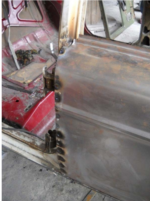
Gráfico 113 Proceso de encuadre carrocería
