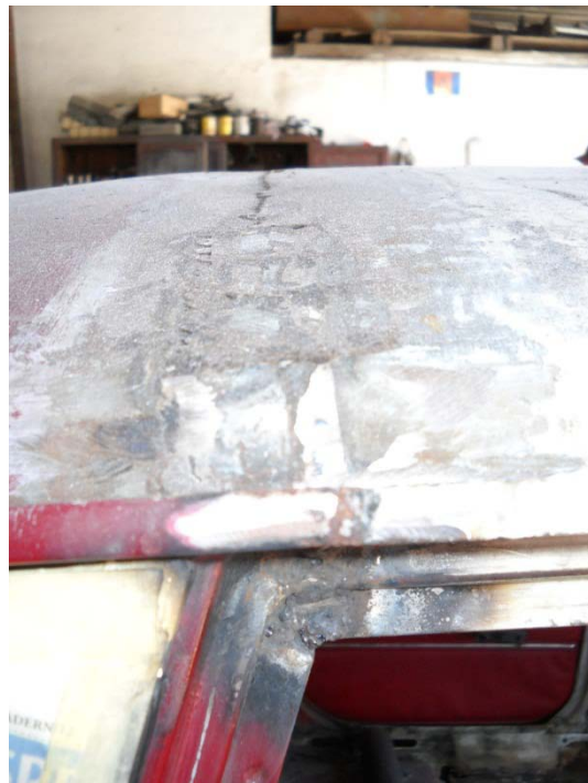
Gráfico 86 Lijado de techo Volvo 244GI
