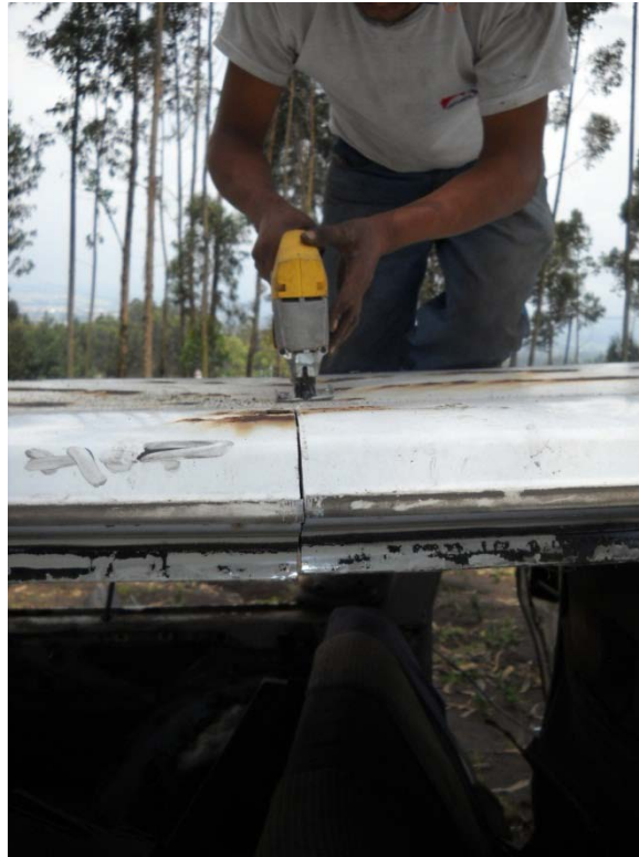
Gráfico 55 Finalización corte techo Volvo 244TE
