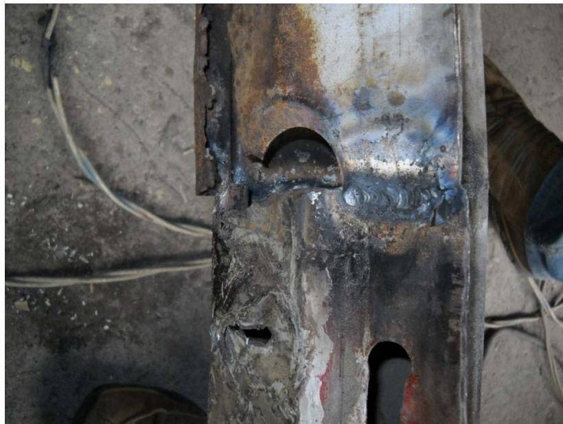
Gráfico 82 Proceso de soldado de travesaño
