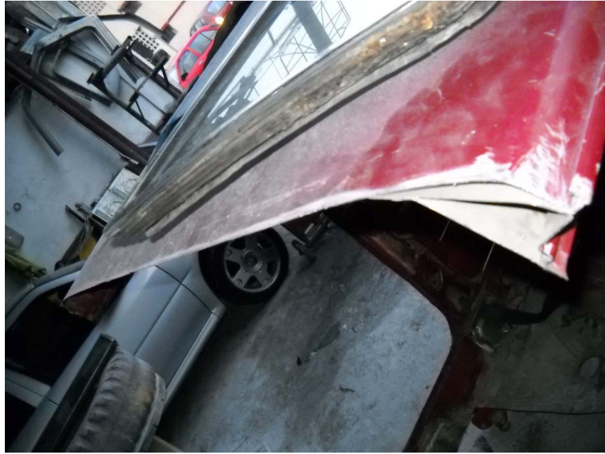
Gráfico 61 Corte de techo Volvo 244GL
