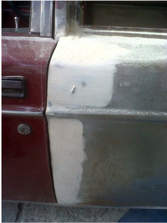
Gráfico 137 Masillado y encuadre de carrocería #2
