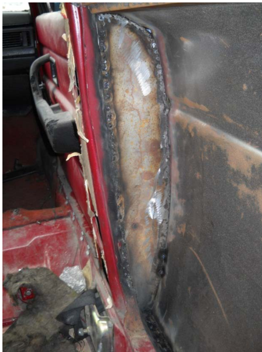
Gráfico 128 Proceso de pulido de piezas en extensión de carrocería #3
