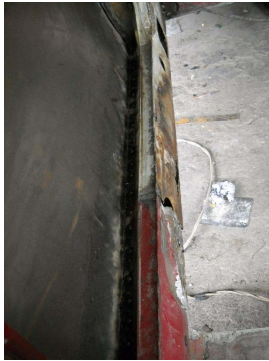
Gráfico 112 Soldado carrocería Volvo 244GL
