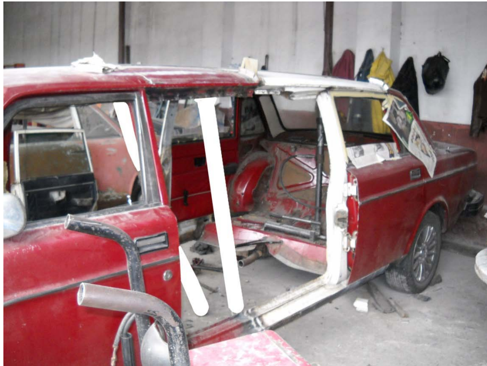
Gráfico 75 Proceso de alargamiento de carrocería vista izquierda
