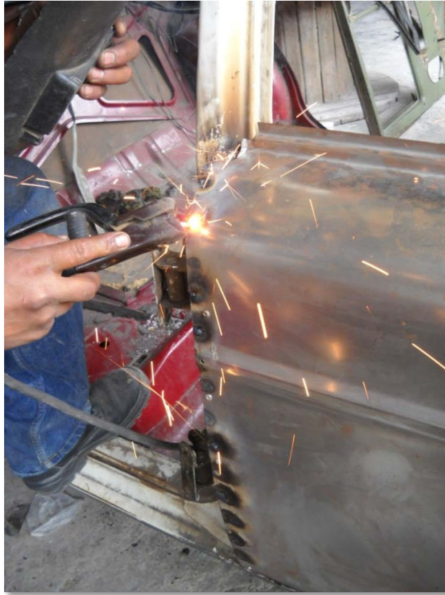
Gráfico 43 Soldadura de los tableros laterales
