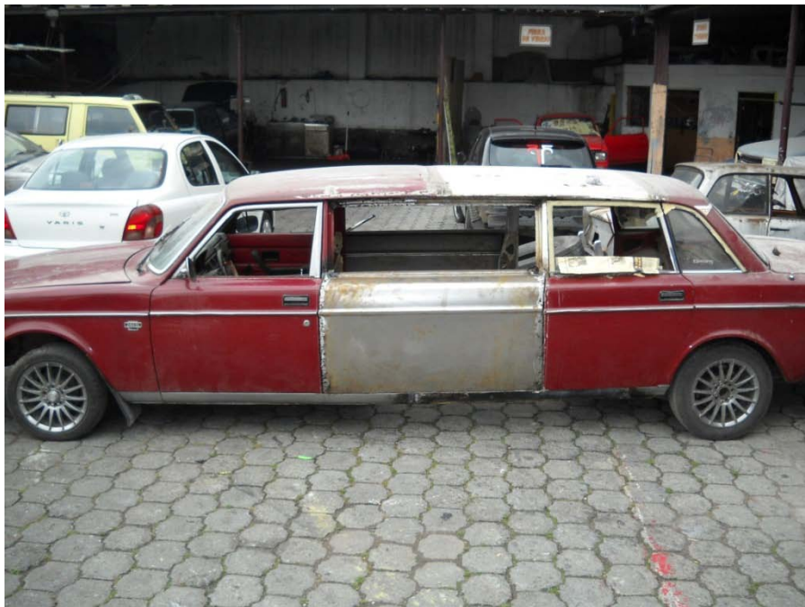
Gráfico 120 Encuadre final de puertas y extensión de carrocería #1
