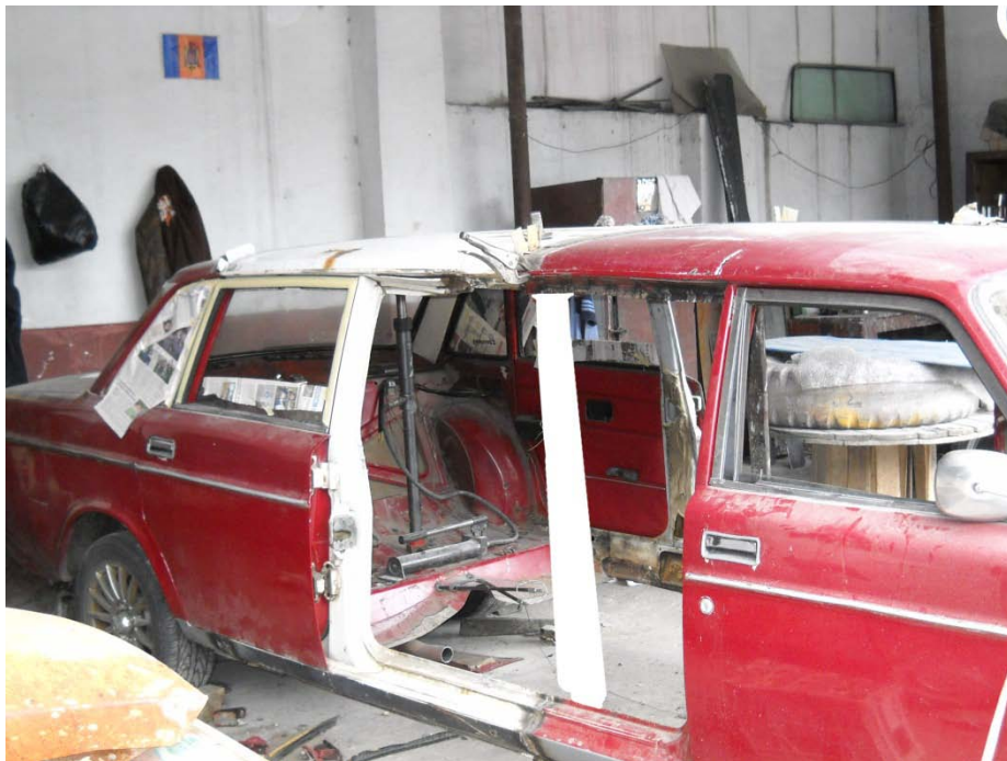
Gráfico 74 Proceso de alargamiento de carrocería vista derecha
