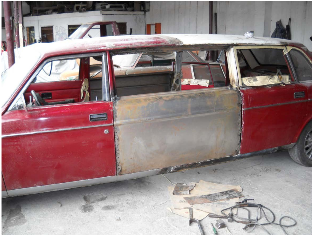
Gráfico 121 Encuadre final de puertas y extensión de carrocería #2
