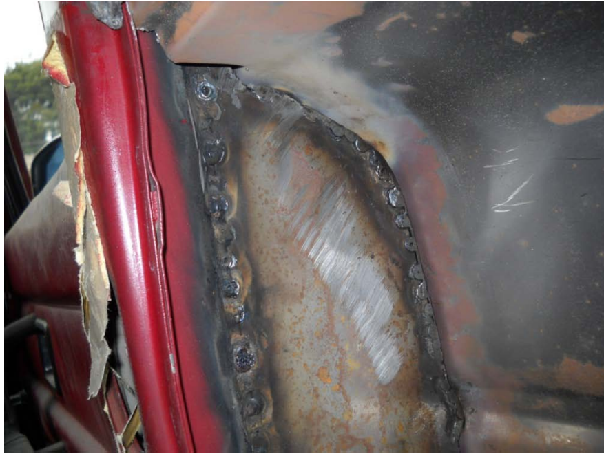
Gráfico 125 Soldado de piezas (Extensión de carrocería) #3
