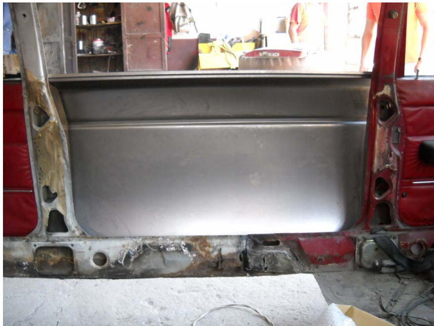
Gráfico 108 Extensión de carrocería Volvo 244GL
