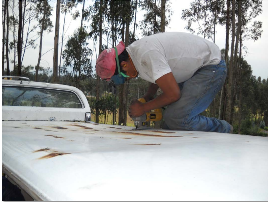
Gráfico 39 Corte del techo del Volvo 244GL
