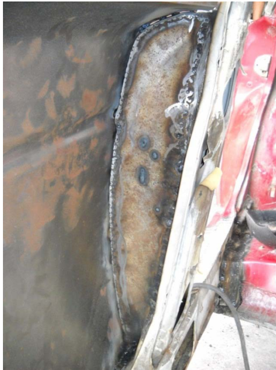
Gráfico 127 Proceso de pulido de piezas en extensión de carrocería #2
