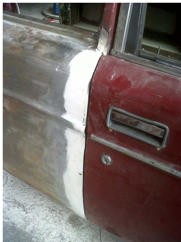
Gráfico 130Masillado y encuadre de carrocería #1
