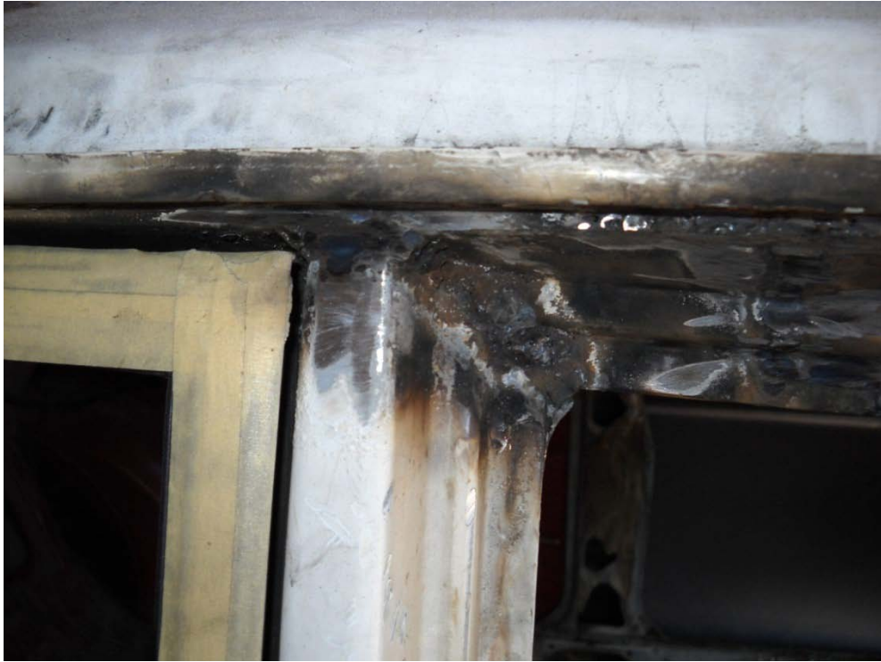
Gráfico 87 Lijado de carroceria Volvo 244GL
