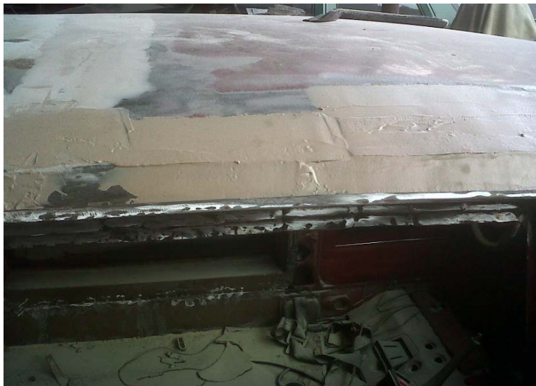
Gráfico 43 Soldadura de los tableros laterales
