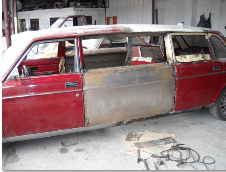
Gráfico 49 Corrección con masilla de toda la carrocería
