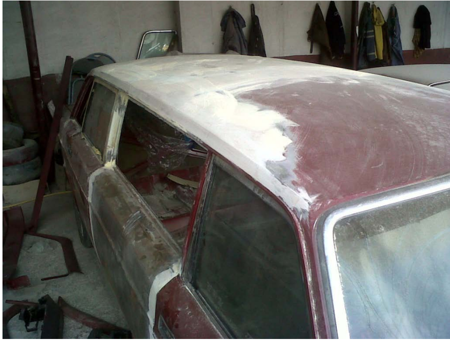
Gráfico 131 Masillado de carrocería Volvo 244 GL #1
