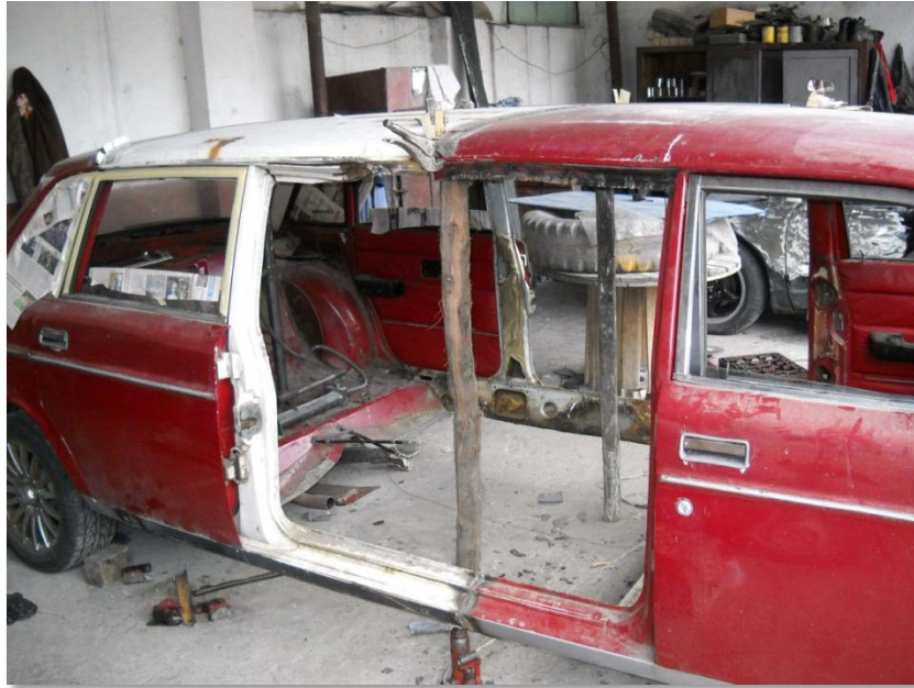
Gráfico 40 Unión mediante soldadura de techo y travesaños
