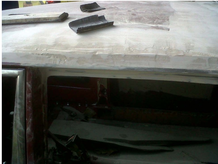
Gráfico 139 Lijado y pulido de carrocería #1
