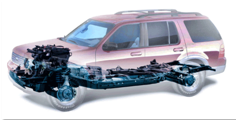
Gráfico 12 Aquí un ejemplo de un vehículo con un sistema de carrocería y chasis separados 12
