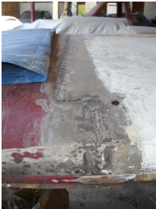
Gráfico 88 Lijado de techo Volvo (Limusina)
