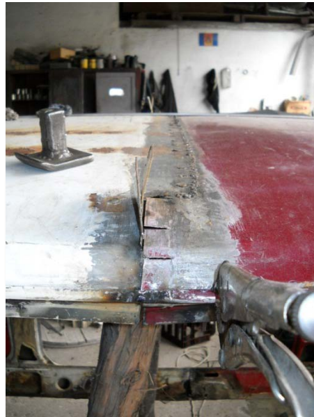
Gráfico 41 Soldadura de techo.
