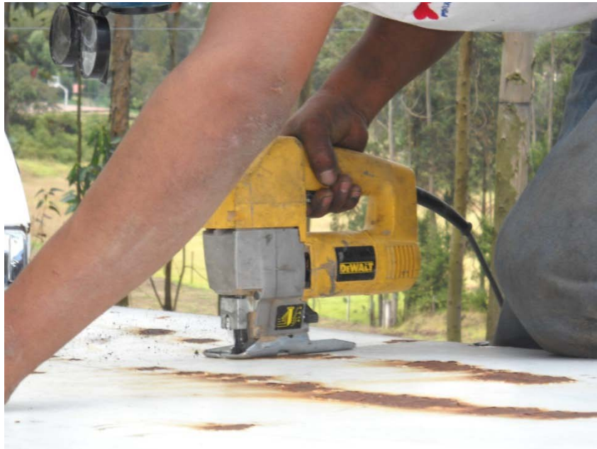
Gráfico 53 Corte de techo Volvo 244 Te (Wagon)
