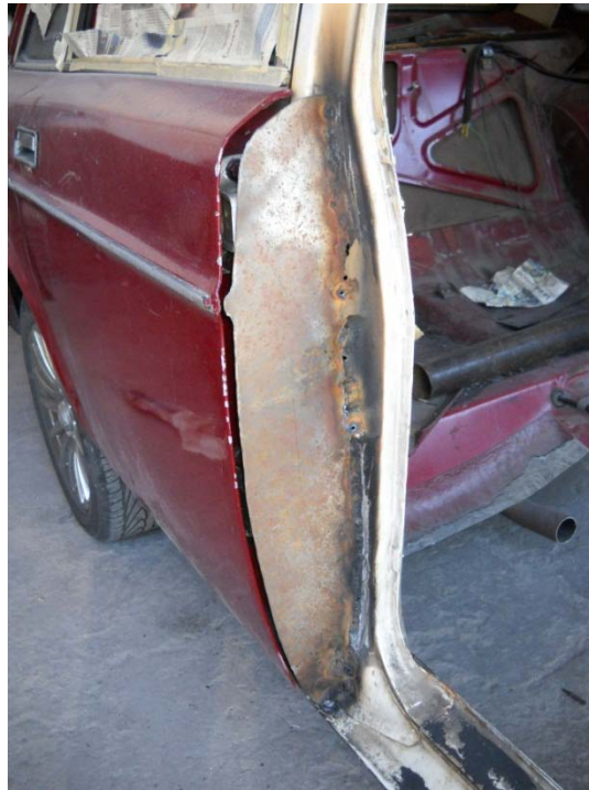
Gráfico 92 Proceso de soldado y alineamiento (Vista Derecha)
