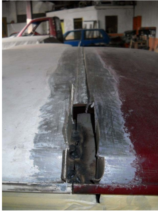
Gráfico 79 Proceso de soldado techo Volvo 244 GL
