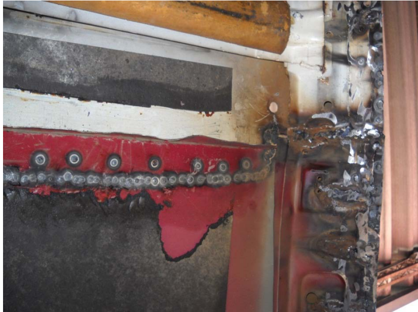
Gráfico 97 Soldado y pulido de carrocería
