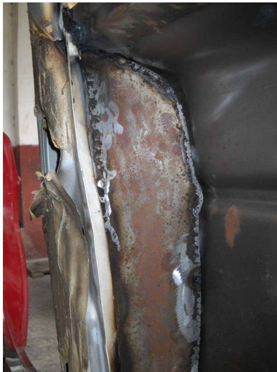
Gráfico 124 Soldado de piezas (Extensión de carrocería) #2
