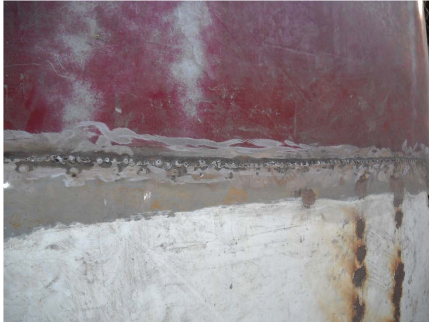
Gráfico 85 Pulido de techo Volvo 244 GL
