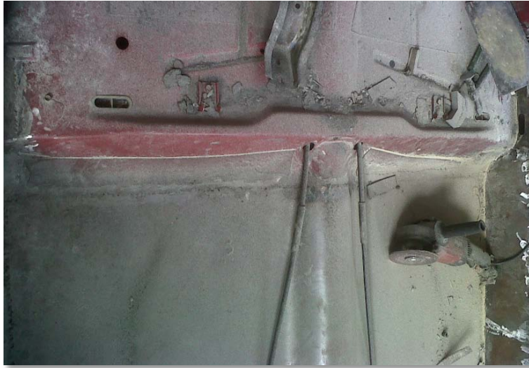
Gráfico 47 Suelda del piso antes mencionado.
