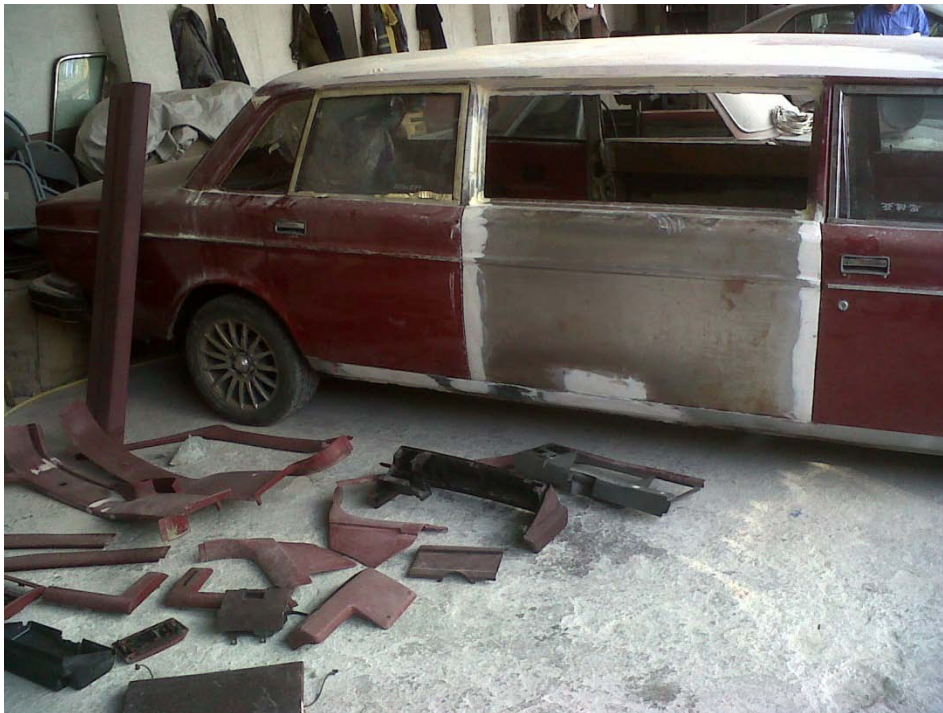
Gráfico 132 Masillado de carrocería Volvo 244 GL #2
