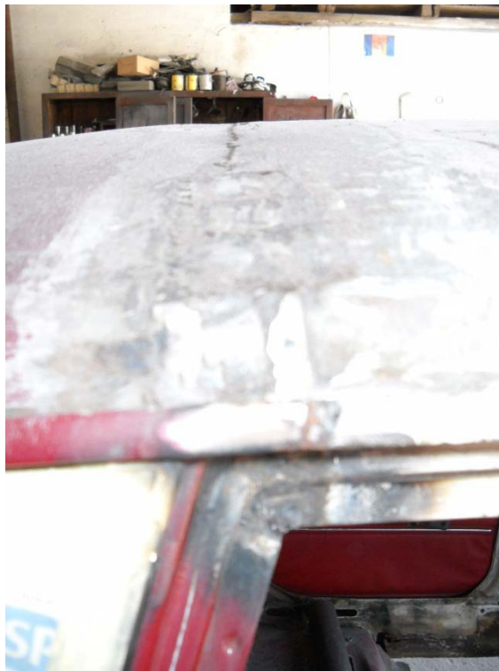
Gráfico 90 Proceso de lijado de carrocería I
