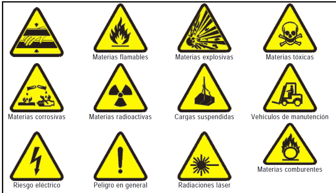
Figura 5.2. Señales de advertencia.
