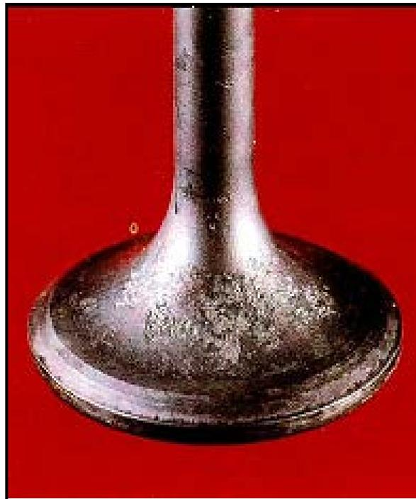
Figura 8 Corrosión de válvula por el azufre del combustible
