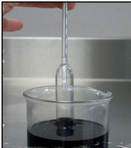
Figura 28 Hidrómetros API para petróleos
