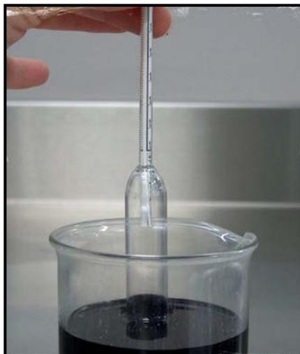
Figura No. P1 - 3 Hidrómetros API para petróleos
