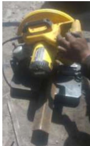
Figura 4.1. Corte de ángulo empenado una tronzadora de Metal
