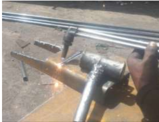
Figura 4.2. Corte de soporte mecanismo de ginebra, oxicorte
