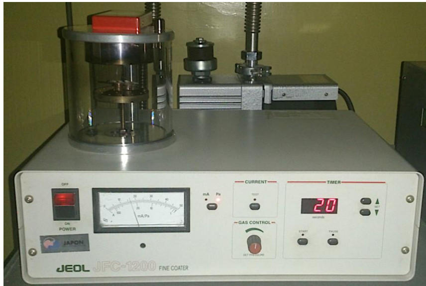
Figura 28.- Máquina recubridora de oro ( Jeol jfc-120, fine coater ).
