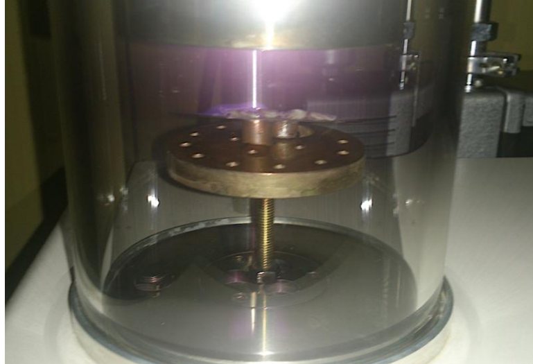
Figura 30.- Acercamiento del proceso de recubrimiento de oro. En esta fotografía se puede observar el destello de color rosa que es cuando se produce la descarga del metal.
