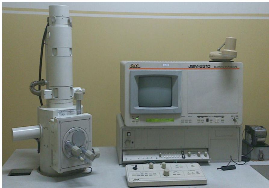
Figura 32.- Microscopio Electrónico de Barrido MEB (Jeol JSM-5310)
