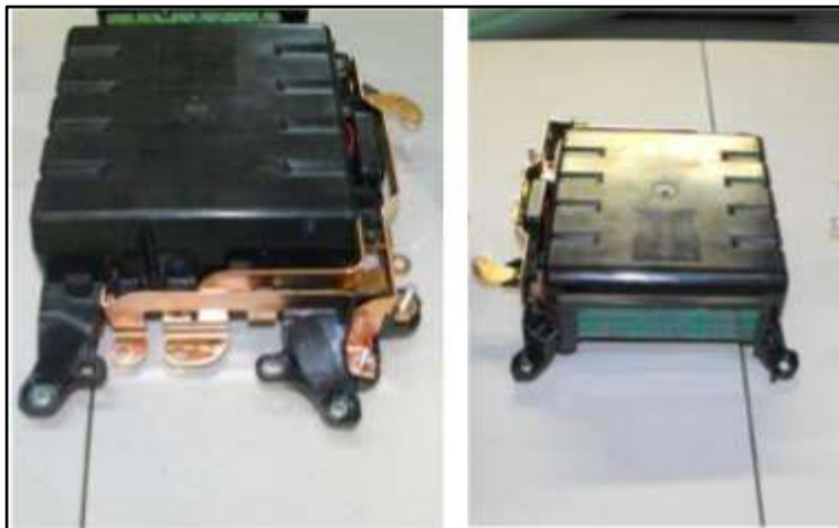
Figura 4. 5 Condensadores del sistema inversor.
