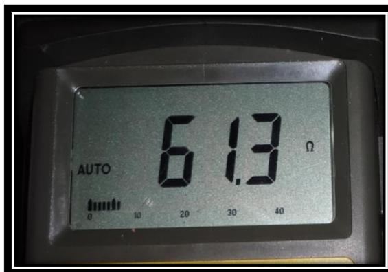
**Figura 39:** Comprobación del sistema CAN-H y CAN-L. Con multímetro.
