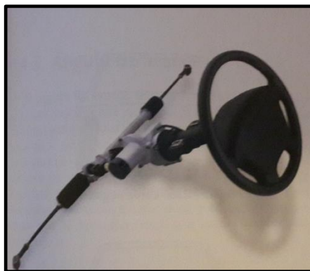
Figura 1.3 Dirección Asistida Eléctricamente. Fuente: Elementos Amovibles, Eduardo Águeda Casado, 2010. Editado por: Leonidas Vaca.
