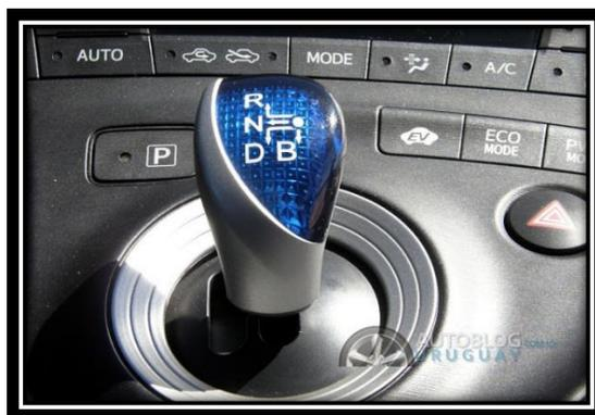
**Figura 2-11.-** Palanca de cambios del Toyota Prius
