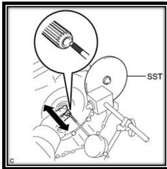
**Figura 4-36.-** Medición de la holgura longitudinal del anillo de retención.
