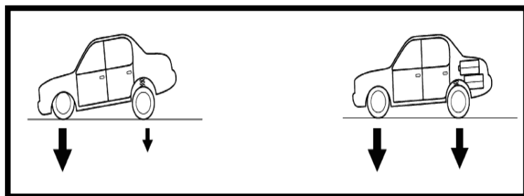
Figura: 1.22: Sistema de Freno EBD Fuente: Manual de Taller de Toyota Editado por: Patricio Tapia.
