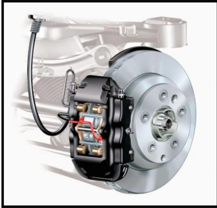
Figura: 2.12: Revisión de desgaste tipo escalón
