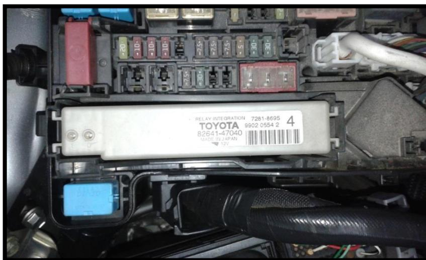
**Figura 2. 6:** Relay Integrador.
