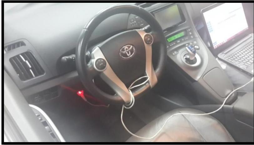
**Figura 2. 4:** Conexión de interfaz con vehículo.
