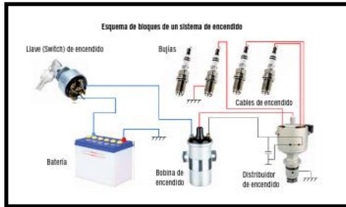
**Figura 1. 16:** Sistema de encendido convencional.
