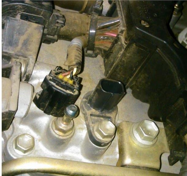
**Figura 2. 19:** Conector del CMP.
