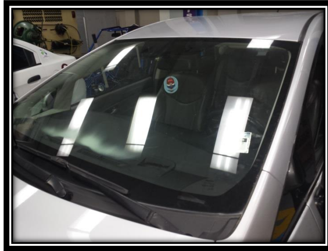
Figura 2. 34: Vidrio laminado sin fracturas.
