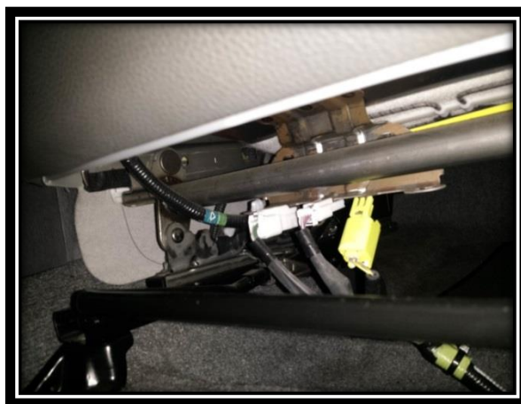
Figura 2. 10: Socket y cable amarillo de despliegue para airbag lateral exterior de asiento.
