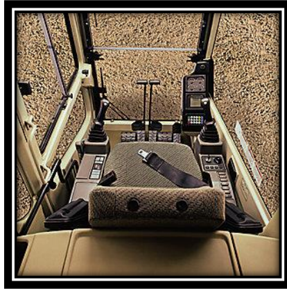
Figura 1. 39: Cinturón de seguridad en maquinaria pesada.
