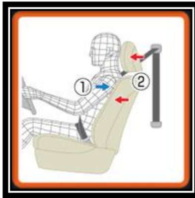
Figura 1. 29: Función de apoyacabezas correcta.
