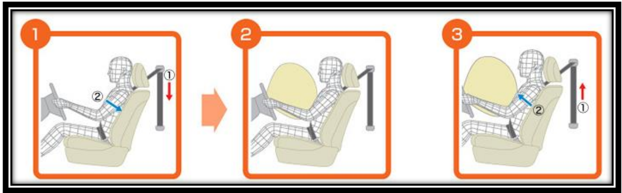
Figura 2. 14: Sinergia entre cinturón de seguridad y Airbag.
