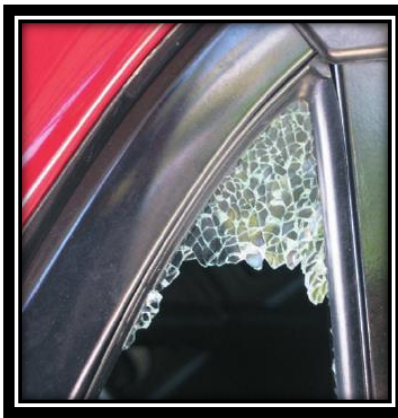
Figura 1. 23: Fractura de vidrio templado.
