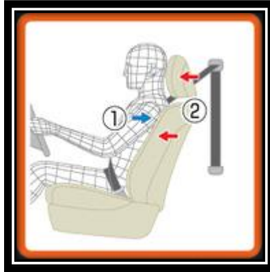
Figura 2. 42: Prueba de apoyacabezas (movimiento de adelante hacia atrás).
