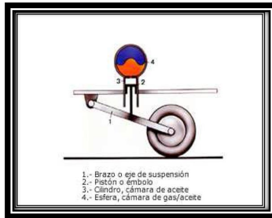
Figura 2. 28 Suspensión hidroneumática.
