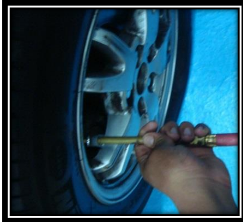
Figura 4. 2 Despresurización del neumático.
