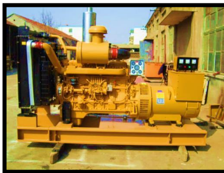
Figura 1.28. Generador de electricidad.
