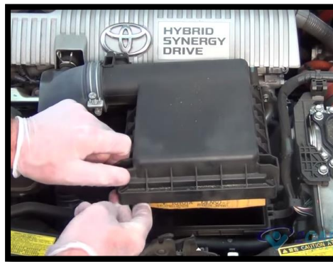
Figura 2.9. Desmontaje de tapa del depurador.
