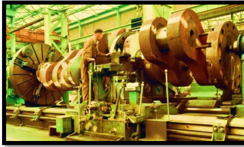
Figura 1.27. Cigüeñal para motor de combustión interna de barco.
