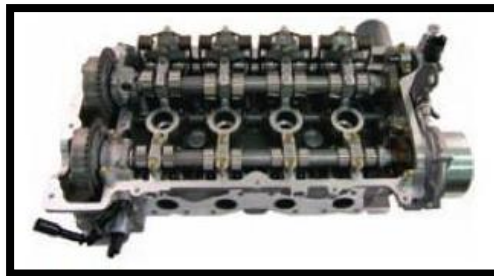
Figura 1.12. Culata de motor con árbol de levas.
