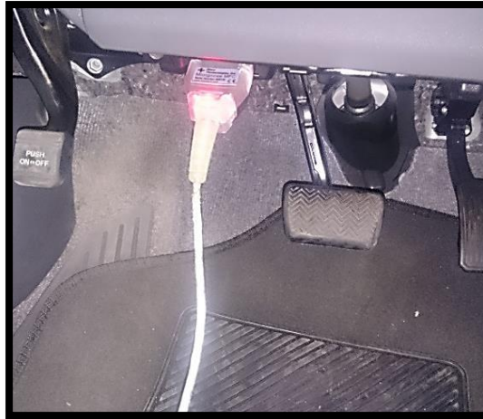
Figura 2.12. Conexión de Techstream al conector de enlace de datos.
