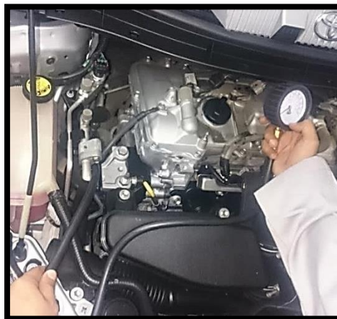
Figura 2.2. Medición de presión del aceite.
