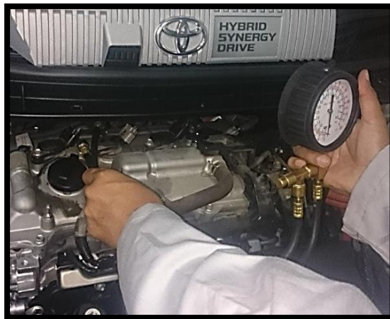
Figura 2.16. Instalación del manómetro de compresión.
