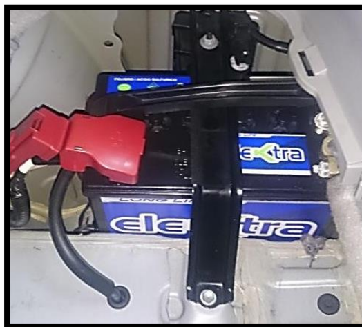
Figura 2.8. Inspección de la manguera de ventilación de batería auxiliar.
