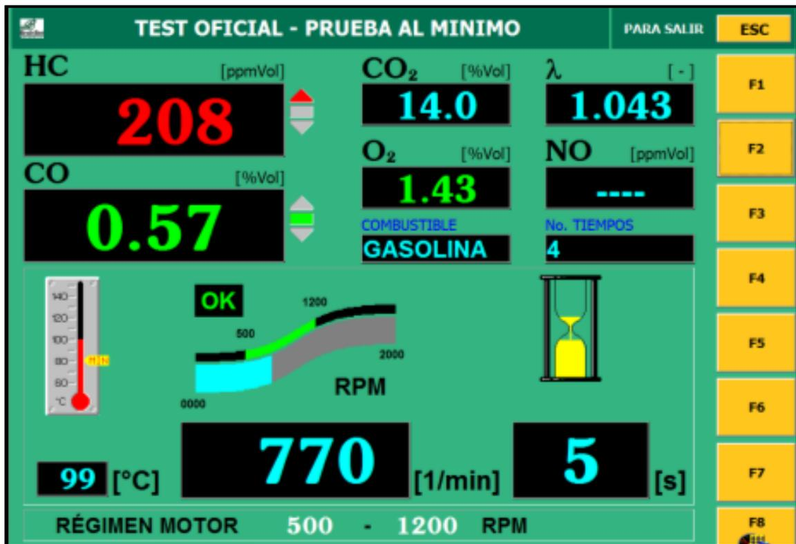
Figura 36. Prueba en Baja (Ralenti 800 R.P.M. – 1200R.P.M.)
