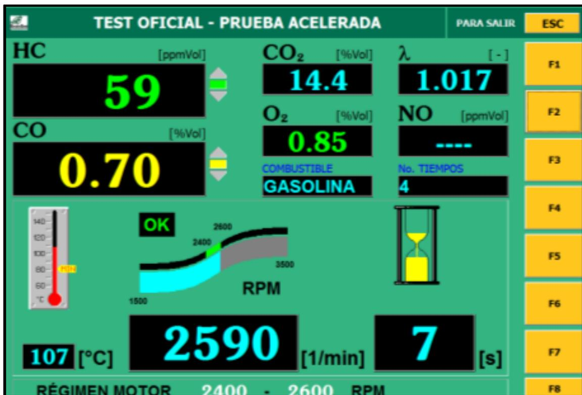
Figura 37. Prueba en alta (2400 R.P.M. – 2600 R.P.M.)
