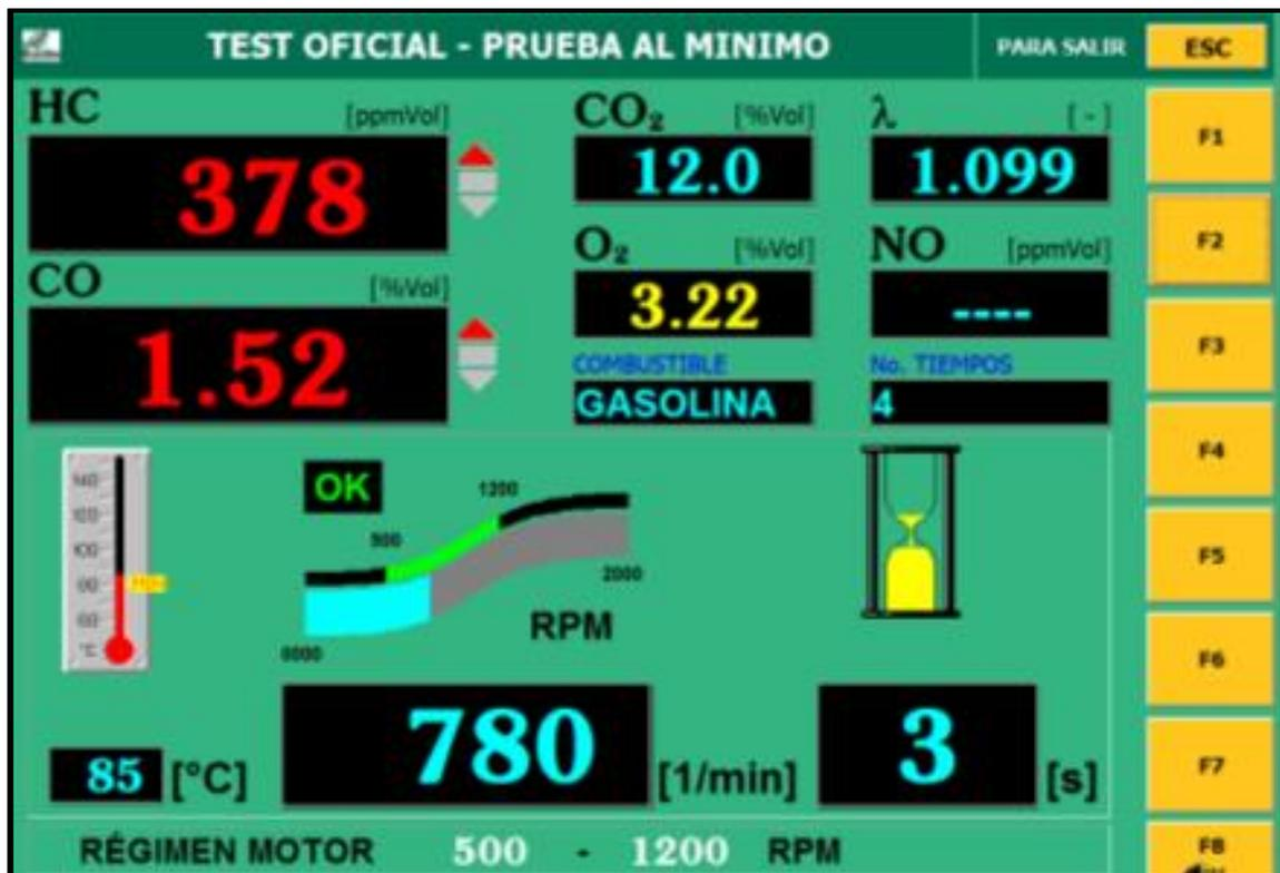
Figura 40. Prueba en Baja (Ralenti 800 R.P.M. – 1200R.P.M.)
