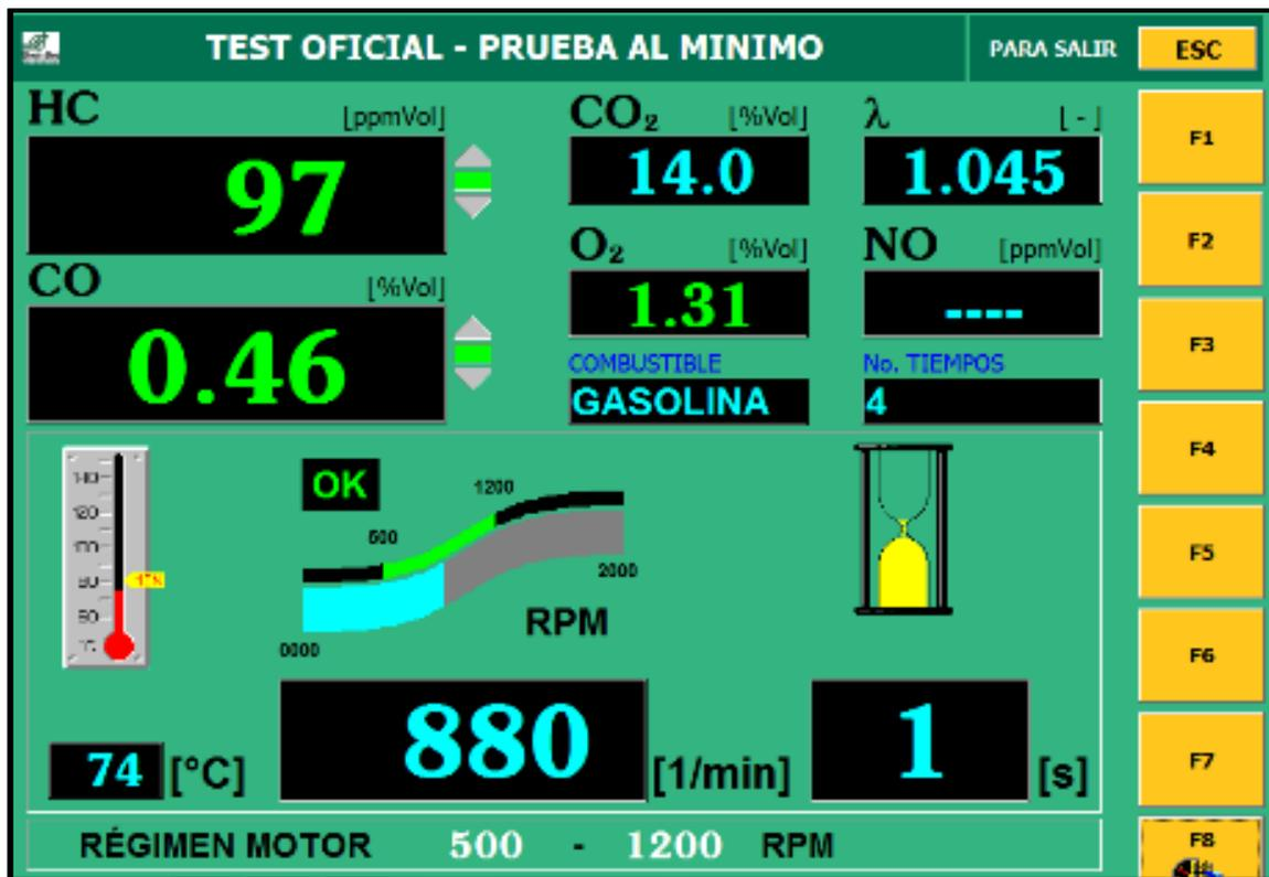
Figura 46. Prueba en baja (ralenti 800 R.P.M. – 1200R.P.M.)
