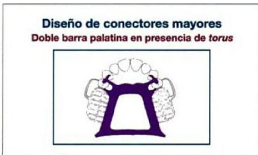
Figura 9 Diseño conector Mayor, Doble Banda Palatina con presencia de Torus.
